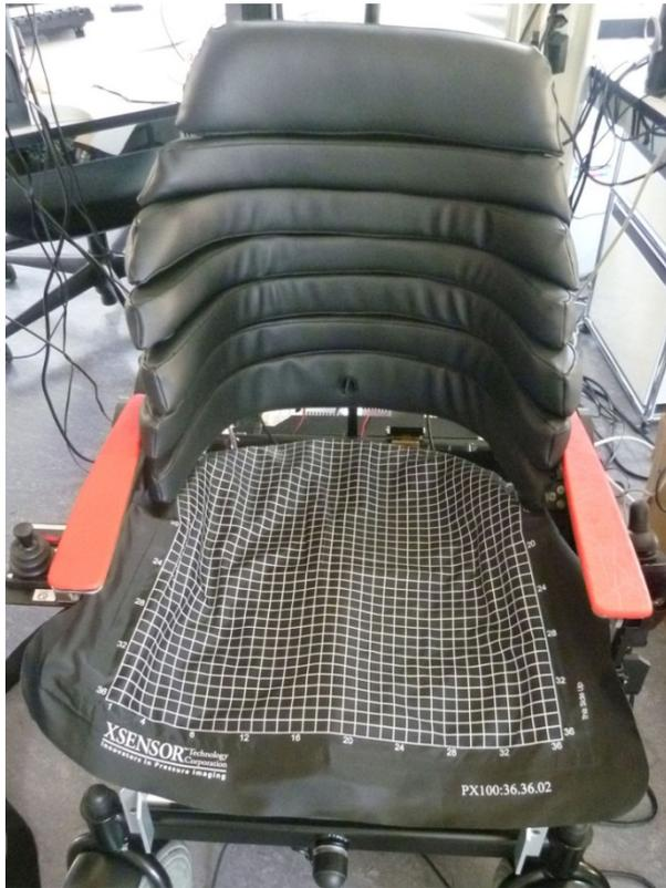
Die Druckmessmatte auf der Sitzfläche eruiert, wie die Rückenlehne die Rollstuhlfahrenden «zwingt», die Sitzhaltung zu verändern, um Druckpunkte zu verlagern.
