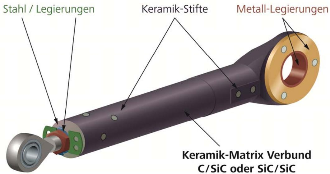
Elektromagnetischer Aktuator aus einer Kombination unterschiedlicher Materialien: Stahl- und Metalllegierungen, Keramik, Keramik-Matrix-Komposite. Diese Kombination zu einem funktionierenden Ganzen zu machen ist die Herausforderung beim europäischen Projekt «ADMACOM».
