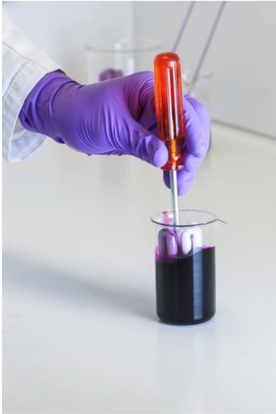
Une nouvelle méthode développée par l'Empa permet de déterminer non seulement le mercure lié mais aussi le mercure gazeux que renferment les lampes économiques fluocompactes. Pour cela la lampe est immergée dans une solution de permanganate de potassium et est brisée à l'aide d'un outil; la solution pénètre alors dans la lampe qui est sous vide et lie le mercure gazeux.
