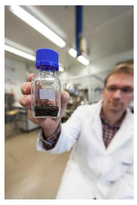
Les zéolites retiennent l'eau produite lors de la méthanisation de l'hydrogène et augmentent ainsi le rendement en méthane du nouveau processus.
