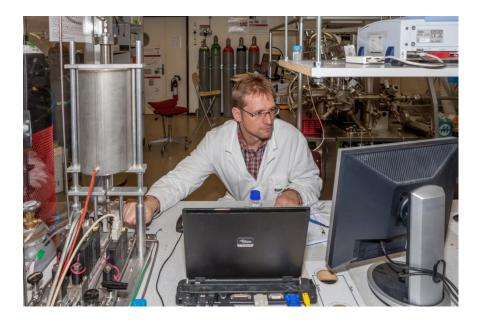
Andreas Borgschulte analyse les processus chimiques qui se déroulent dans le prototype de réacteur de méthanisation (à gauche sur la photo).
