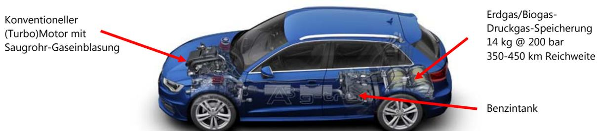
Abb. 5: Beispiel-Erdgasfahrzeug mit üblicher Unterflur-Gasspeicherung (Quelle: Audi, Internet)
