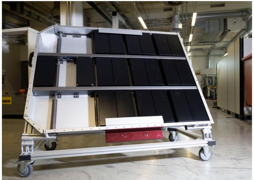
**Benteler entwickelte ein Faltkastenprinzip für einen skalierbaren Batteriekasten aus Edelstahl mit integrierter Kühlplatte. Gefertigt wird er mit der BrightLine Weld-Technologie von Trumpf. (Bilder: Trumpf)**
