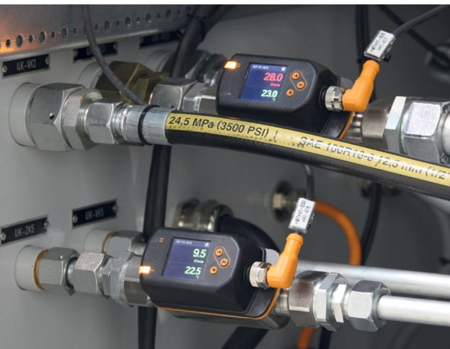
**Spart Kosten: Zwei Messwerte (Durchflussmenge und Temperatur) mit nur einem Sensor.**
