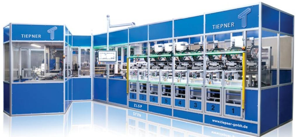
**Tiepner hat die rund acht Meter lange, fünf Meter breite und drei Meter hohe ZLSP-Anlage für die Einpersonen-Bedienung im Dreischichtbetrieb konzipiert. (Bilder: Tox Pressotechnik)**
