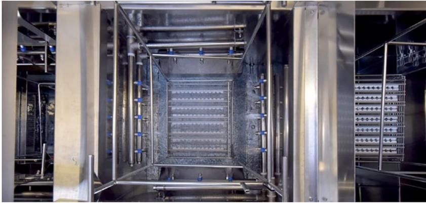
**In den speziell für die Feinstreinigung entwickelten Tauch-Spritz-Spülen werden die Teile beim Herausfahren abgespritzt, was den Spüleffekt verbessert. (Bild: Zeiss)**
