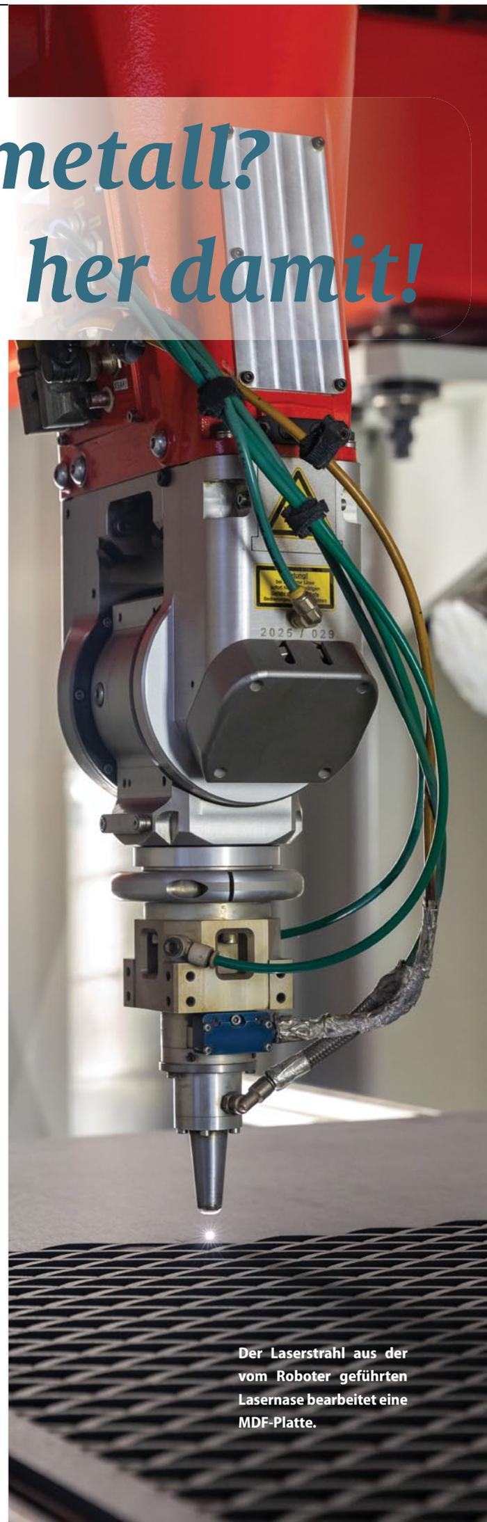
Der Laserstrahl aus der vom Roboter geführten Lasernase bearbeitet eine MDF-Platte.
