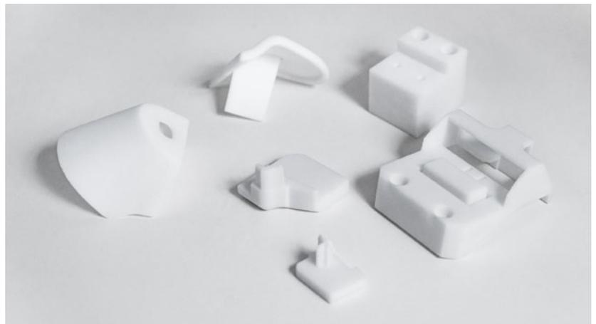
**Knaus Tabbert nutzt den 3D-Druck für die Herstellung von Prototypen und für Serienkomponenten, wie etwa Halterungen für Alarmanlagen. Für das Post Processing kommt eine S1-Anlage von AM Solutions zum Einsatz. (Bild: Knaus Tabbert)**
