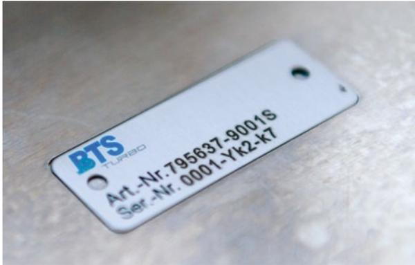
**Laser-Schild, hergestellt auf dem eSolarMark-System.**
