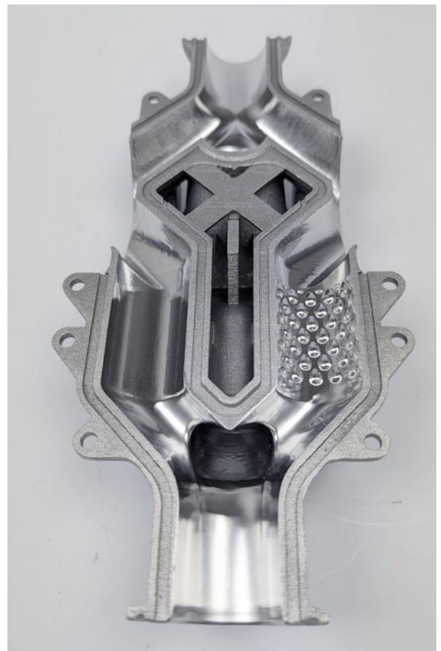
**Blick in das Innere eines Ventilblocks, wie er in Anlagen der Pharma- beziehungsweise der Lebensmittelbranche eingesetzt wird. Wissenschaftler der Fraunhofer-Gesellschaft haben dieses Teil additiv gefertigt. Da es insbesondere an den produktführenden Stellen keine Schweißnähte gibt, kann eine bessere Reinigung gewährleistet werden. (Bild: Fraunhofer IWU)**
