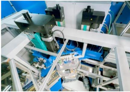
**Im Laminator sind drei elektromechanische Servopressen-Antriebe verbaut: zwei in den Heizpressen und einer in der Kühlpresse.**
