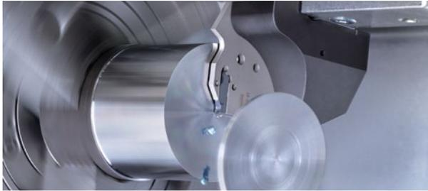
Das neue Abstechwerkzeug besteht aus einem Schwert mit drei integrierten Plattensitzen. (Bild: Tungaloy)
