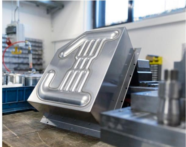
**Speziell für Benteler entwickelt: Die MultiFokus-Optik bringt mit BrightLine Weld Spitzenergebnisse beim porenfreien, gasdichten Schweißen von Aluminium.**
