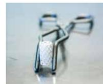
Beim Kaltstart eines Benzinmotors entstehen weit mehr Feinstaub und Schadstoffe als während der Fahrt. Empa-Forscher heizen den Katalysator daher mit Mikrowellen vor, damit dieser sofort effizient arbeitet.
