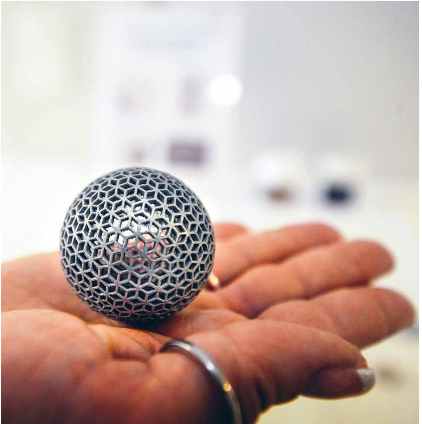
Eine Gitterkugel aus einer AlSi10Mg-Legierung, hergestellt im Additive-Manufacturing-Verfahren bei der ProtoShape GmbH, danach gestrahlt und geschliffen.
