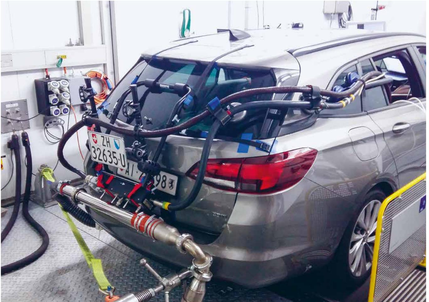
Ein Opel Astra 1.6 CDTI im Abgaslabor der Empa. Die Leitungen verbinden den Auspuff mit einem mobilen PEMS-Messgerät («portable emission measuring system») im Inneren des Autos. Nach der Kalibrierung des Messaufbaus im Abgaslabor geht es dann so auf die Strasse.
