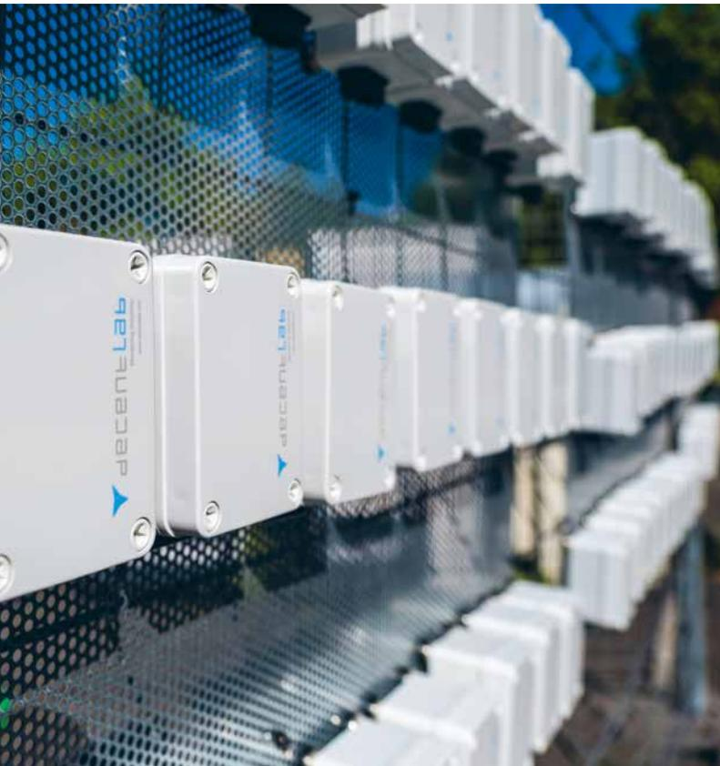
Low-Cost-Sensoren des Empa-Spin-off Decentlab während der Funktionskontrolle vor der Installation in der ganzen Schweiz. (Quelle: Decentlab GmbH)
