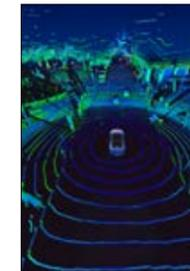
Wie gut können selbst fahrende Autos sehen? Das Testfahrzeug der Empa hat einen Laserscanner an Bord, der solche hochauflösenden Standbilder produziert. Zusätzlich braucht es Kameras und Radarscanner. Die Empa will herausfinden, wie exakt die Sensoren die Welt erkennen. Seite 17.
