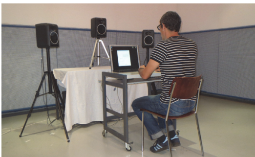
Abb. 2: Möglicher Aufbau eines Hörversuchs im Labor
