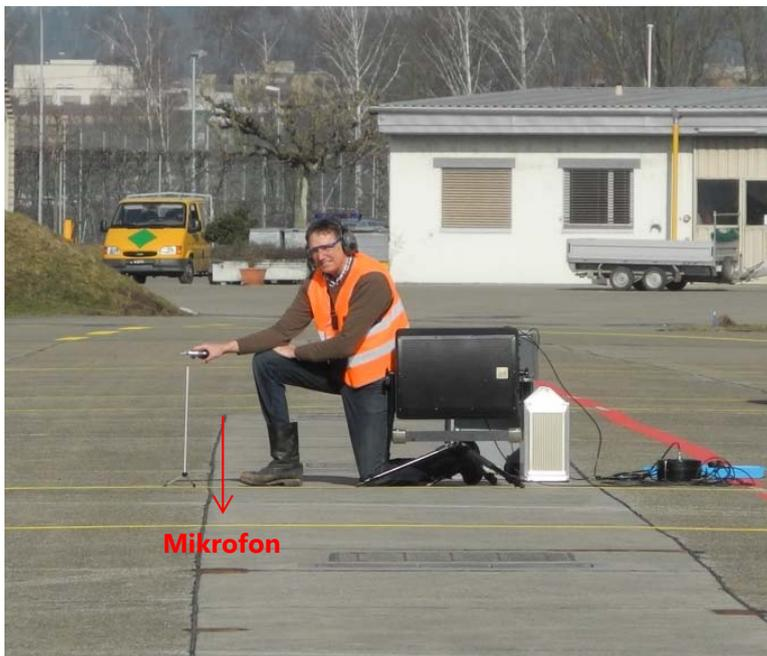
Abbildung 5: Quellenpositionen: links Signalpistole, rechts Lautsprecher Electrovoice Sx325; beide auf 0,5 m über Boden
