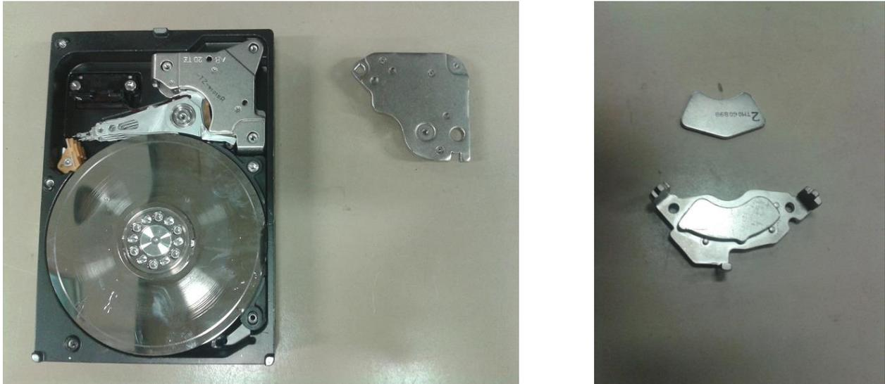
Abbildung 6-2: Harddisk mit Neodym-Eisen-Bor Magneten (Fotos: Umtec)
