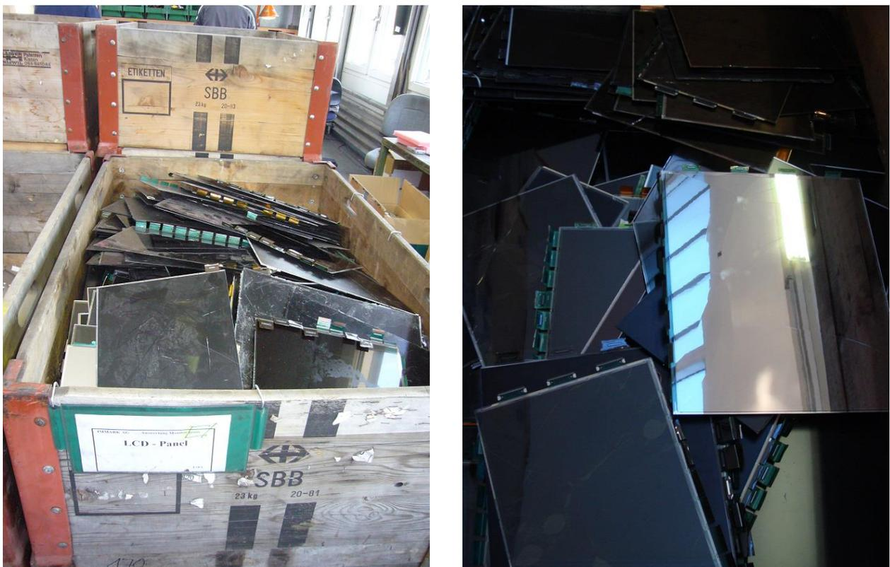
Abbildung 6-1: LCD-Panels aus der Zerlegung von Flachbildschirmen (Fotos: Empa)
