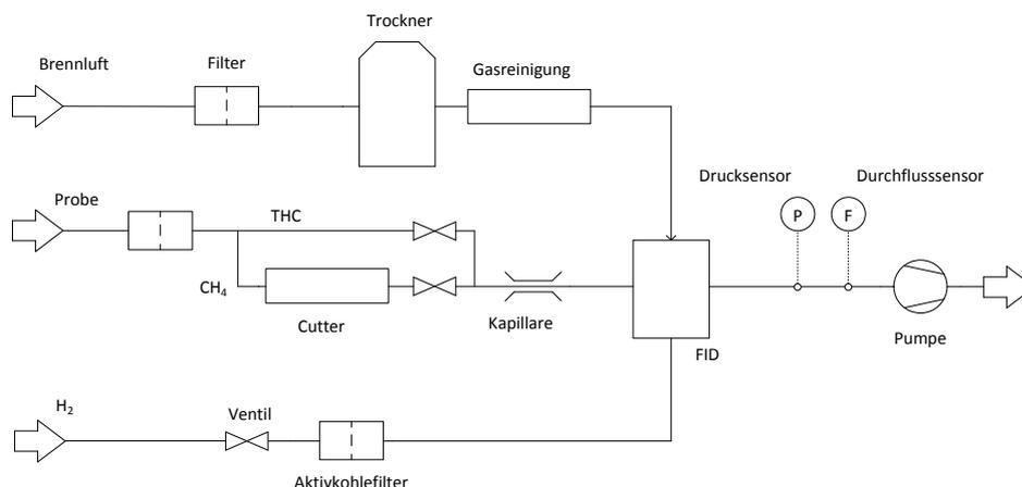
Abb. 3-14: Schematischer Geräteaufbau eines Messgerätes für Nichtmethankohlenwasserstoffe
