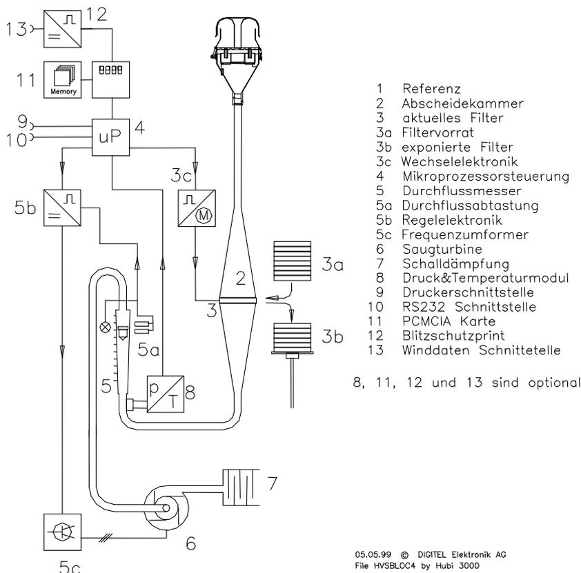
Abb. 3-16: Schematische Darstellung eines Probenahmeegerätes DHA-80 von Digital
