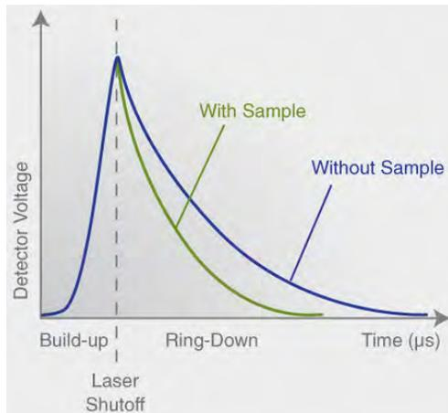
Abb. 3-13: Abnahme der Lichtintensität mit und ohne Beitrag durch Absorption an Gasmolekülen (Quelle: www.picarro.com)
