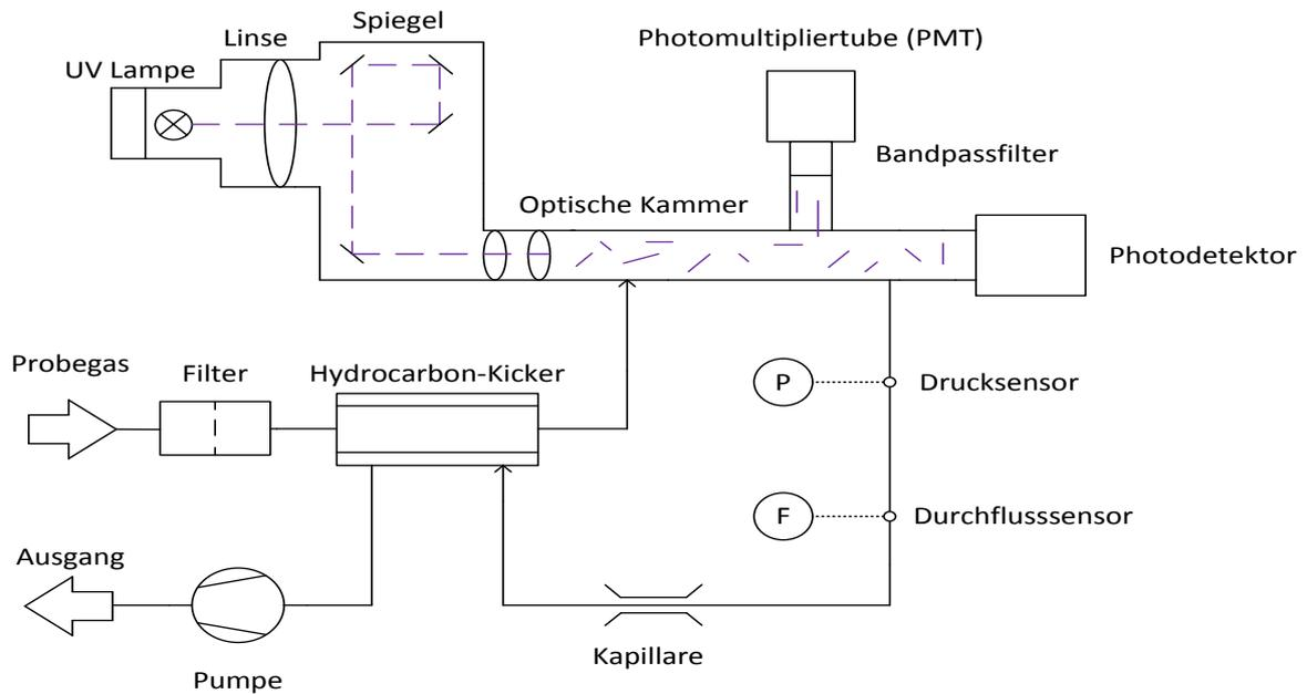
Abb. 3-2: Schematischer Geräteaufbau eines SO<sub>2</sub>-Messgerätes
