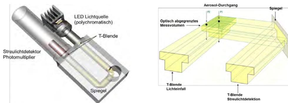
Abb. 3-17: Aufbau des Sensors des Fidas Messsystems und Veranschaulichung der T-Blende (Quelle: Bedienungsanleitung Feinstaubmonitorsystem Fidas, PALAS GmbH)
