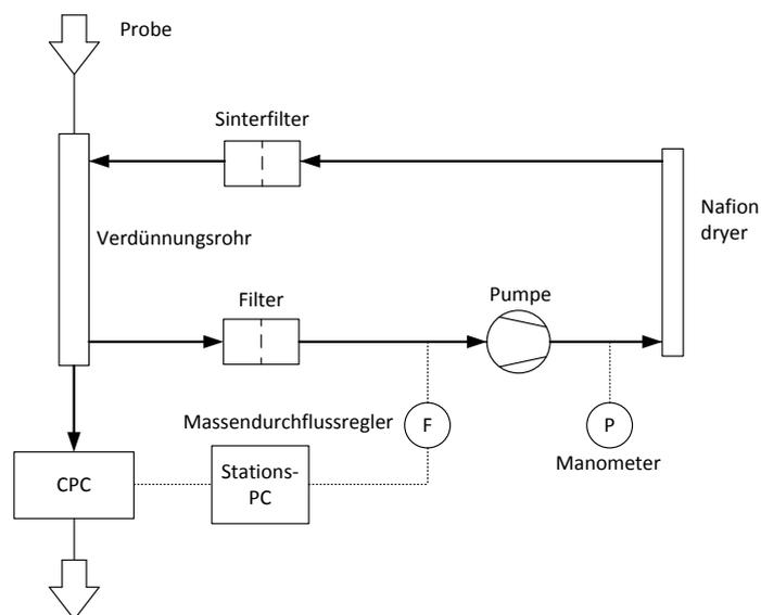
Abb. 3-23: CPC-Verdünnungseinheit
