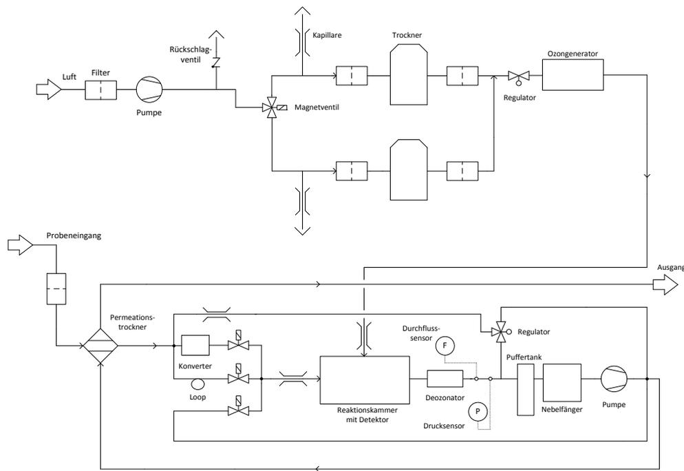
Abb. 3-4: Schematischer Geräteaufbau eines NO<sub>x</sub>-Messgerätes
