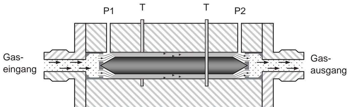
Abb. 4-3: Schema des Messprinzips des DHI Molbloc/Molbox1
