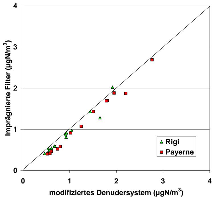
Abb. A2-9: Vergleich der Messungen von Salpetersäure+Nitrat mit dem modifizierten Denudersystem mit den parallelen Summenmessungen auf imprägnierten Filtern.
