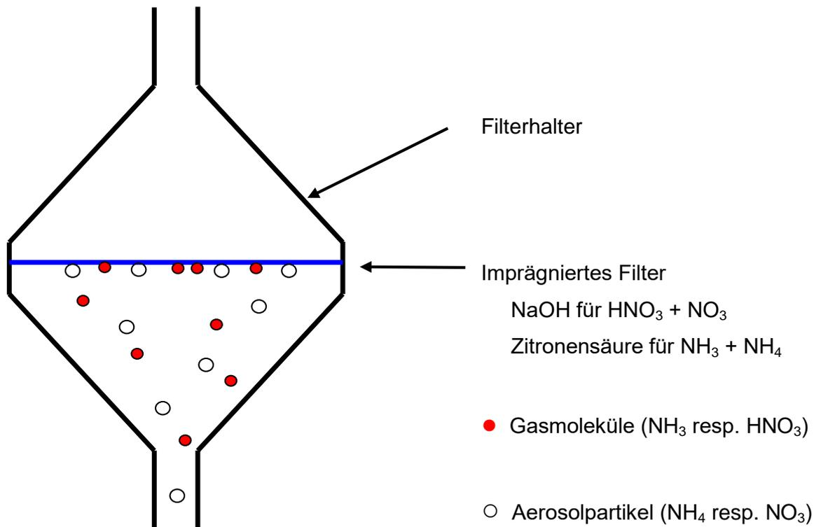
Abb. A2-1: Schematische Darstellung des Messprinzips mit imprägnierten Filtern zur Messung der Summen von Salpetersäure+Nitrat, resp. Ammoniak+Ammonium
