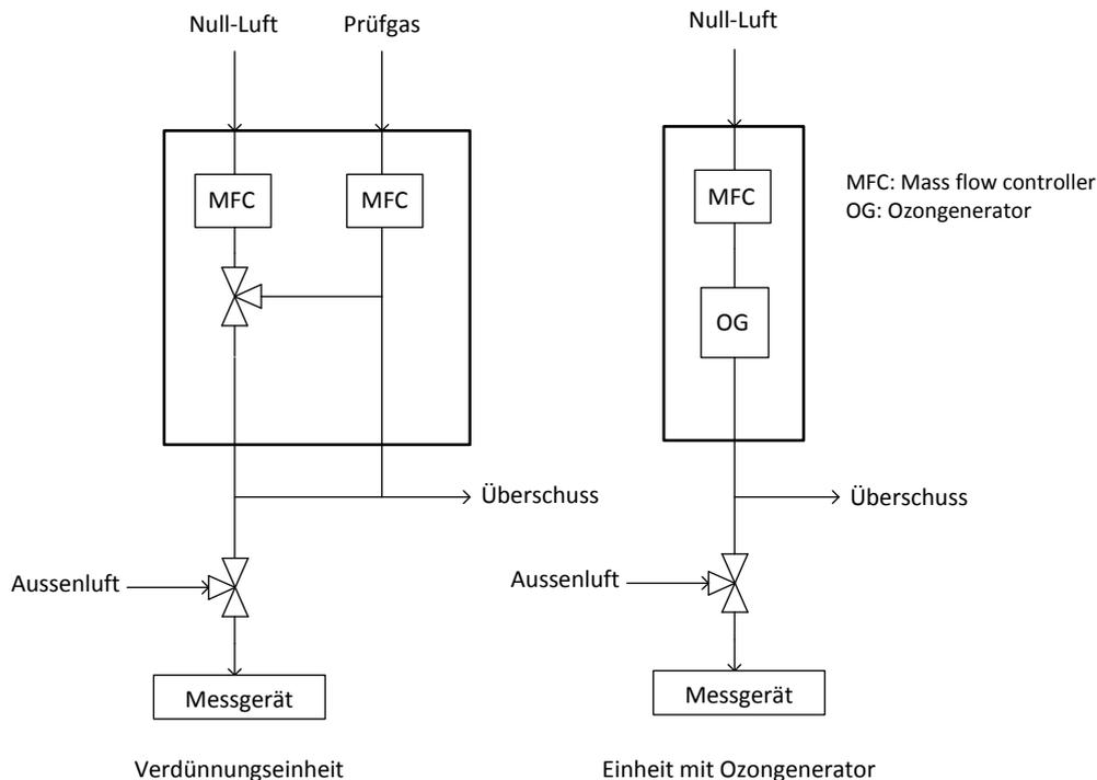
Abb. 4-9: Schematische Darstellung einer Kalibriereinrichtung
