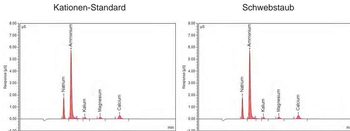
Abb. 3-20: IC-Chromatogramm Kationen-Standard und Kationen im Schwebstaub
