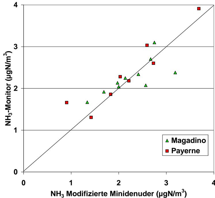
Abb. A2-10: Vergleich von gasförmigem Ammoniak, gemessen mit modifizierten Minidenudern und dem photoakustischen Monitor (TGA310 Omnisens).
