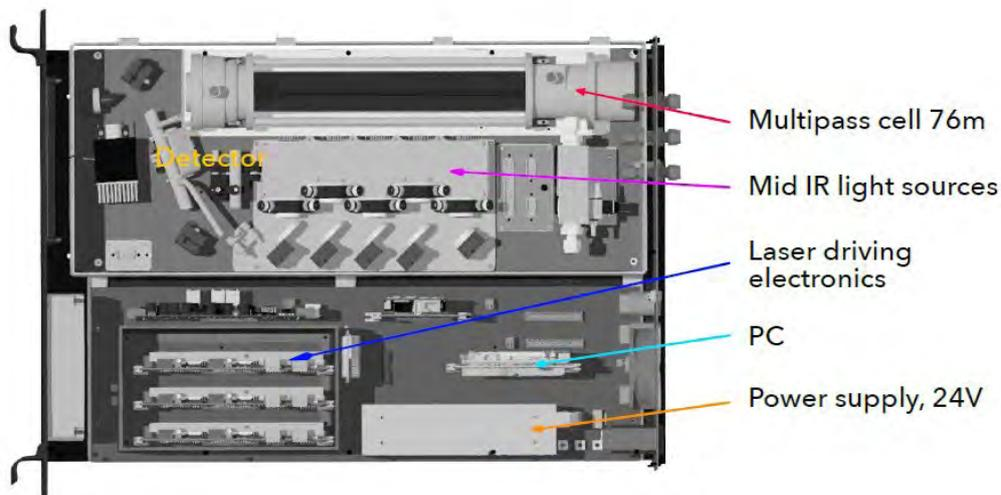
Abb. 3-8: Schematischer Geräteaufbau vom MIRO NO<sub>2</sub>-Gas Analyzer (3D CAD Model MIRO)
