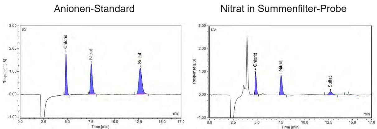
Abb. 3-28: IC Chromatogramm Anionen-Standard und Summenfilter-Probe (Nitrat)
