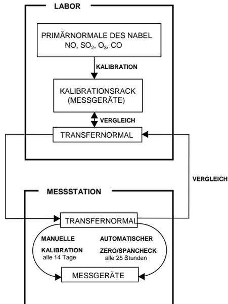
Abb. 4-7: Rückverfolgbarkeit Komponenten CO, NO, O<sub>3</sub> und SO<sub>2</sub>
