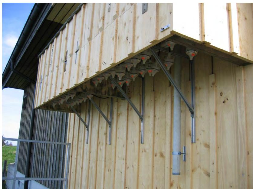
Abb. 3-27: Probenahme Stickstoffaerosole
