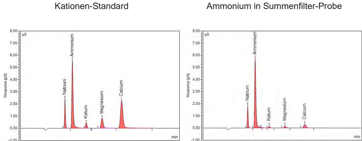
Abb. 3-29: IC- Chromatogramm Kationen - Standard + Summenfilter-Probe
