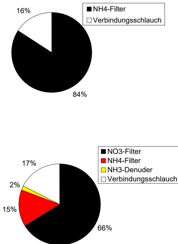
Abb. A2-7: Deposition von Ammonium (oben) und Nitrat (unten) beim DELTA-Minidenudersystem. Schwarz: Abscheidung am richtigen Ort, auf dem dafür vorgesehenen imprägnierten Filter. Farbig/Weiss: Abscheidung auf anderen Komponenten des Systems (Depositionsverluste im System).
