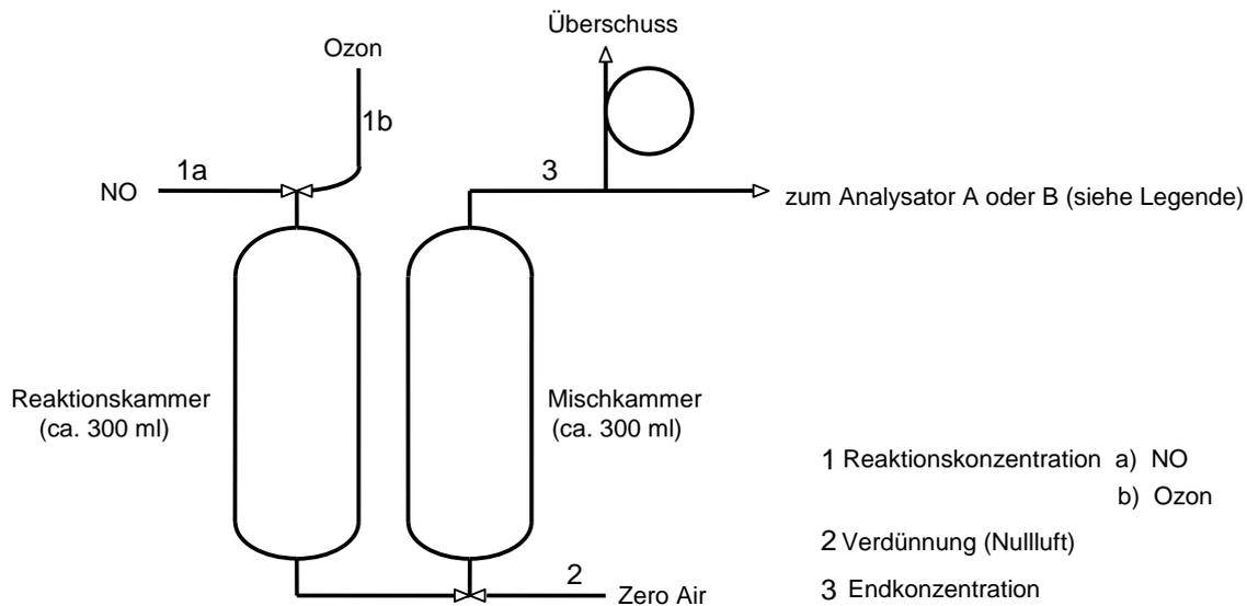
Abb. 3-6: Detaillierte Darstellung der Reaktions- und Mischkammer
