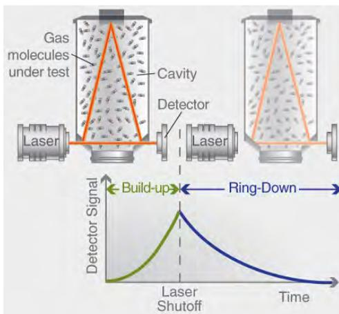
Abb. 3-12: Schematische Darstellung des Cavity Ring Down Spektrometers
