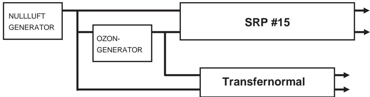
Abb. 4-4: Messanordnung für den Vergleich des Ozon-Transfernnormal mit dem SRP
