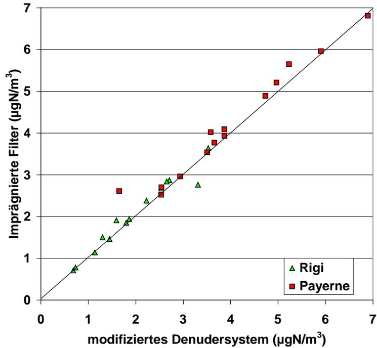
Abb. A2-8: Vergleich der Messungen von Ammoniak+Ammonium mit dem modifizierten Denudersystem mit den parallelen Summenmessungen auf imprägnierten Filtern.
