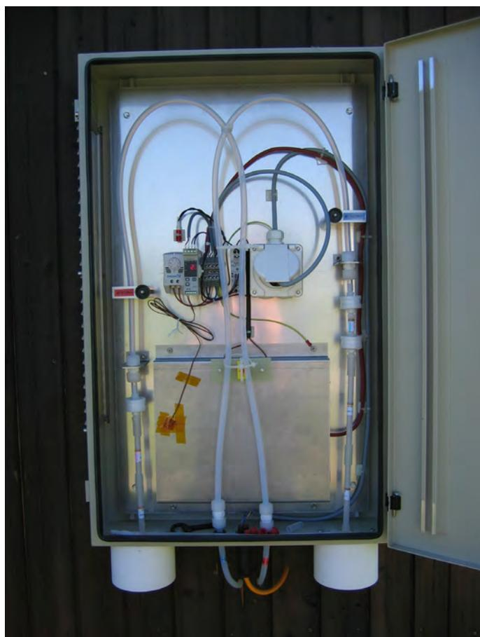
Abb. 3-31: Probenahme Minidenunder-System (MD-System)
