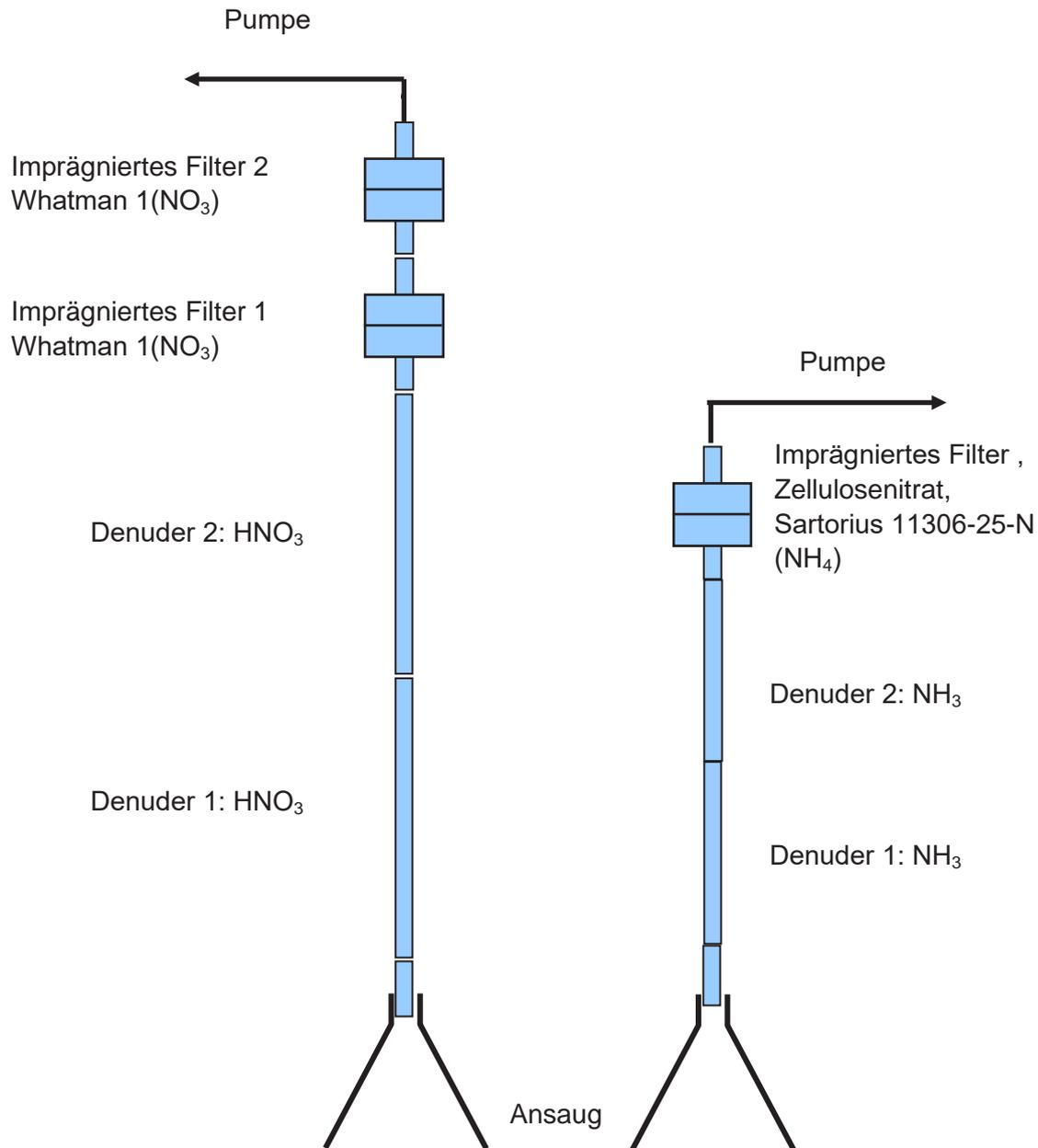
Abb. A2-4: Anordnung der Komponenten im modifizierten Minidenudersystem mit getrennten Linien für Salpetersäure/Nitrat und Ammoniak/Ammonium
