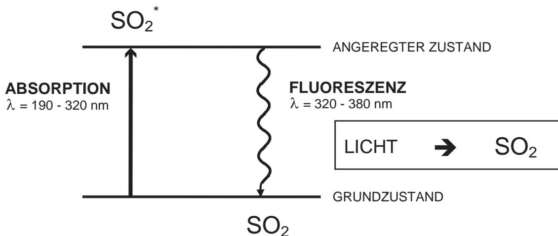
Abb. 3-1: Reaktionsprinzip
