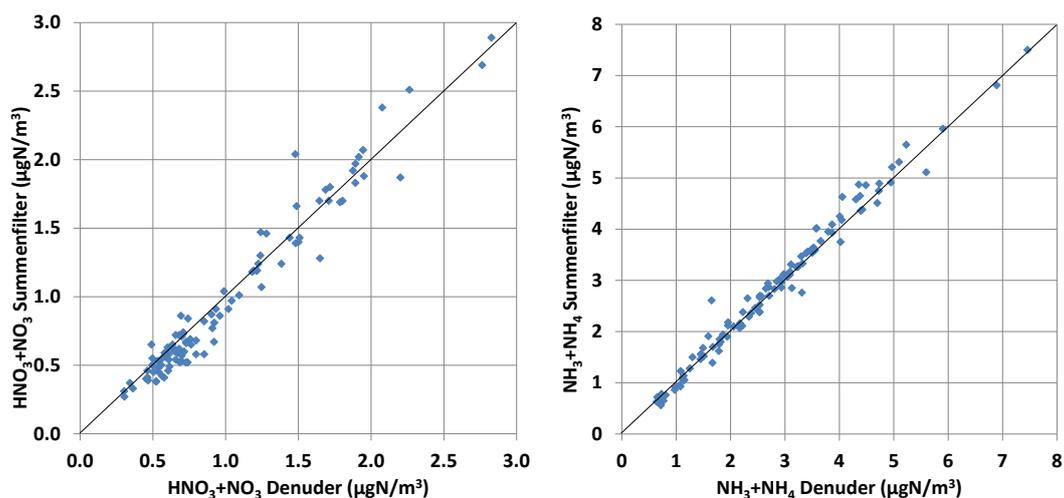
Abb. A2-11: Vergleich der mit dem Minidenudersystem gemessenen Summen  $\text{NH}_3+\text{NH}_4$  resp.  $\text{HNO}_3+\text{NO}_3$  mit den täglichen Summenmessungen mit imprägnierten Filtern in Payerne und Rigi 2009 und 2010.
