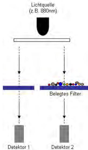
Abb. 3-21: Schematischer Geräteaufbau eines Russmonitor Magese Aethalometer
