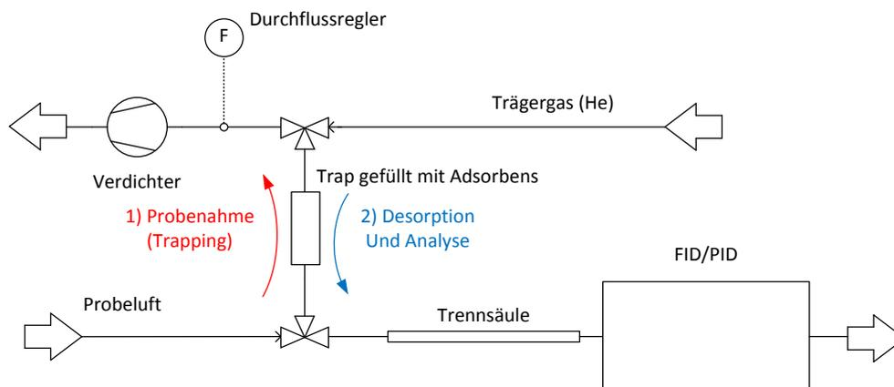
Abb. 3-15: Vereinfachte Darstellung des Messprinzips (Beromünster: FID; Bern, Dübendorf: PID)
