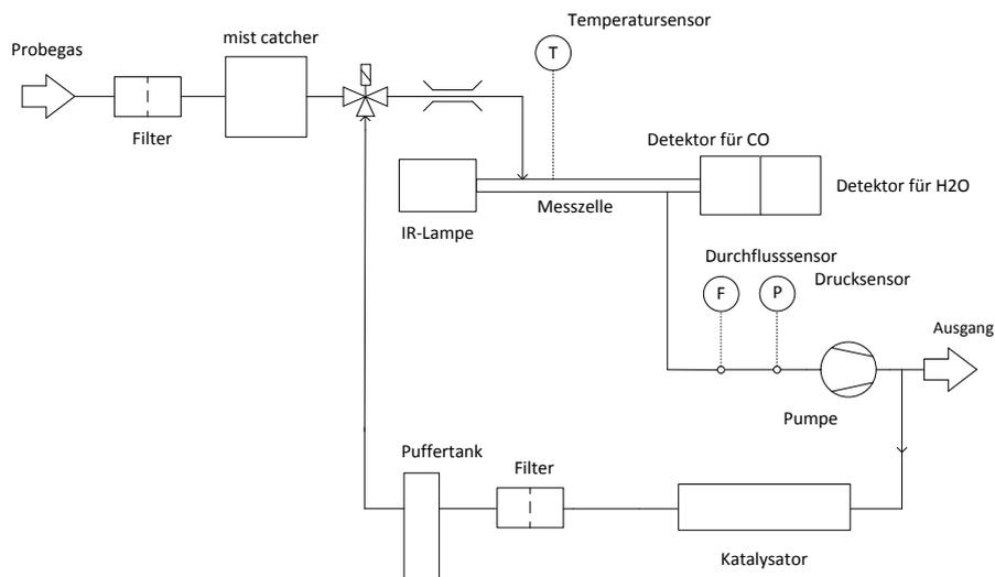
Abb. 3-11: Schematischer Geräteaufbau eines CO-Messgerätes
