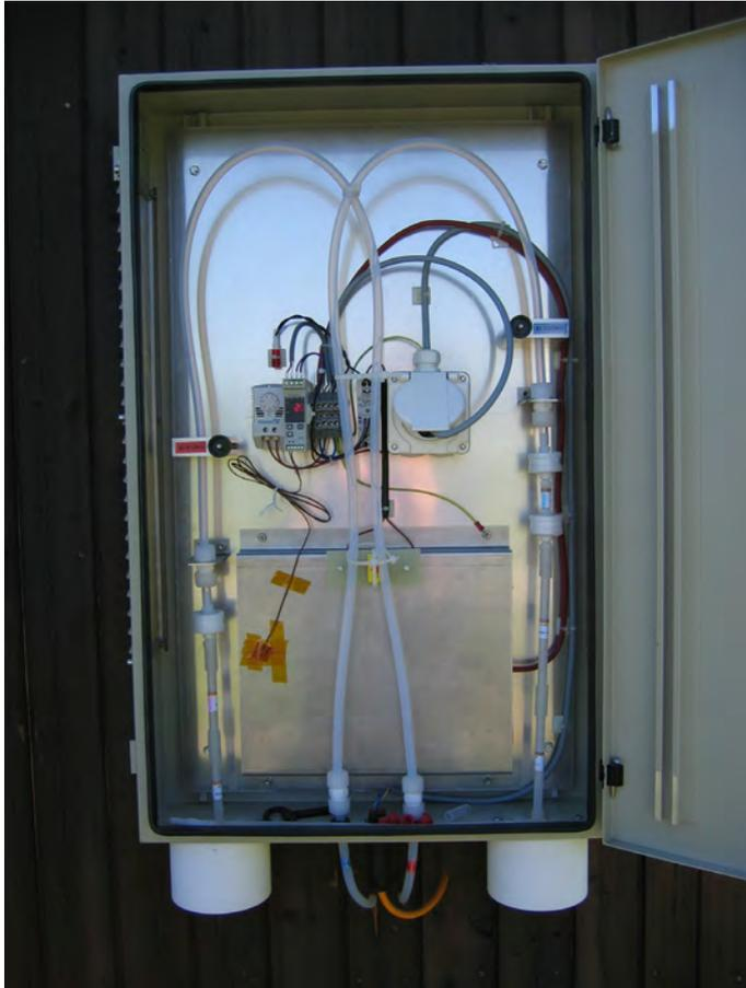
Abb. 3-33: Probenahme Minidenuder-System (MD-System)
