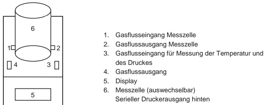
Abb. 4-6: Schematischer Aufbau des DryCal
