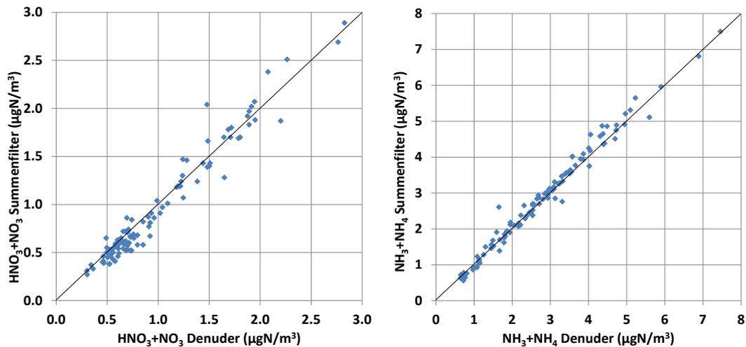
Abb. A5-11: Vergleich der mit dem Minidenudersystem gemessenen Summen  $\text{NH}_3+\text{NH}_4$  resp.  $\text{HNO}_3+\text{NO}_3$  mit den täglichen Summenmessungen mit imprägnierten Filtern in Payerne und Rigi 2009 und 2010.
