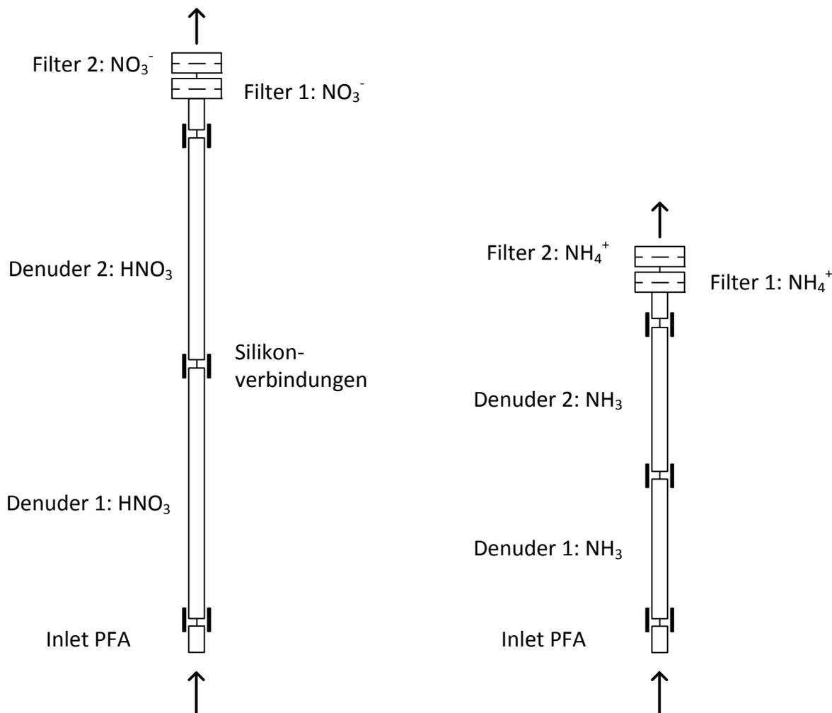
Abb. 3-35: Probetrains zur getrennten Bestimmung von HNO<sub>3</sub>, NO<sub>3</sub><sup>-</sup> und NH<sub>3</sub>, NH<sub>4</sub><sup>+</sup>
