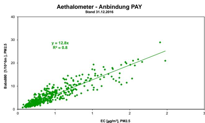
Abb. A4-6: Vergleich von kontinuierlichen Aethalometer-Messungen mit EC-Messungen (TOT Messungen) am Standort Payerne (Messperiode: 23.3.2008 - 31.12.2016)
