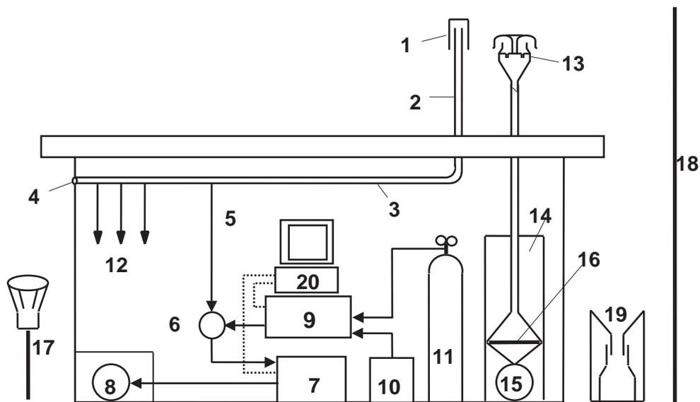
Abb. 2-50: Schematischer Aufbau einer NABEL-Station
