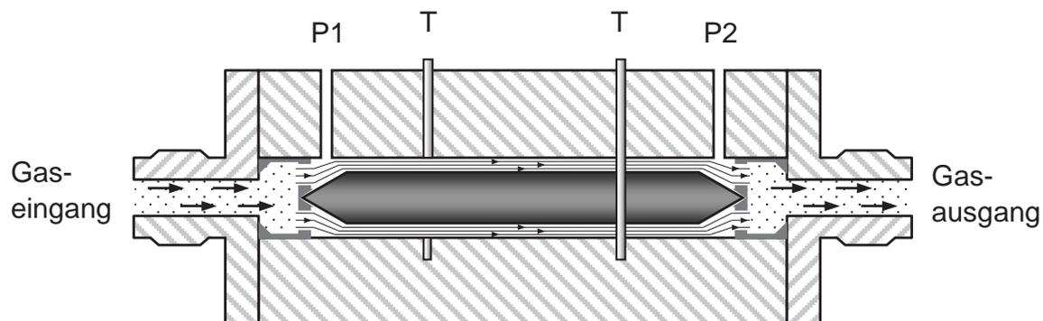
Abb. 4-3: Schema des Messprinzips des DHI Molbloc/Molbox1
