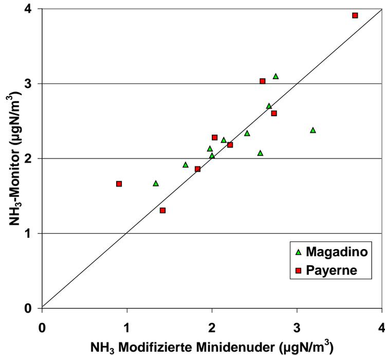
Abb. A5-10: Vergleich von gasförmigem Ammoniak, gemessen mit modifizierten Minidenudern und dem photoakustischen Monitor (TGA310 Omnisens).
