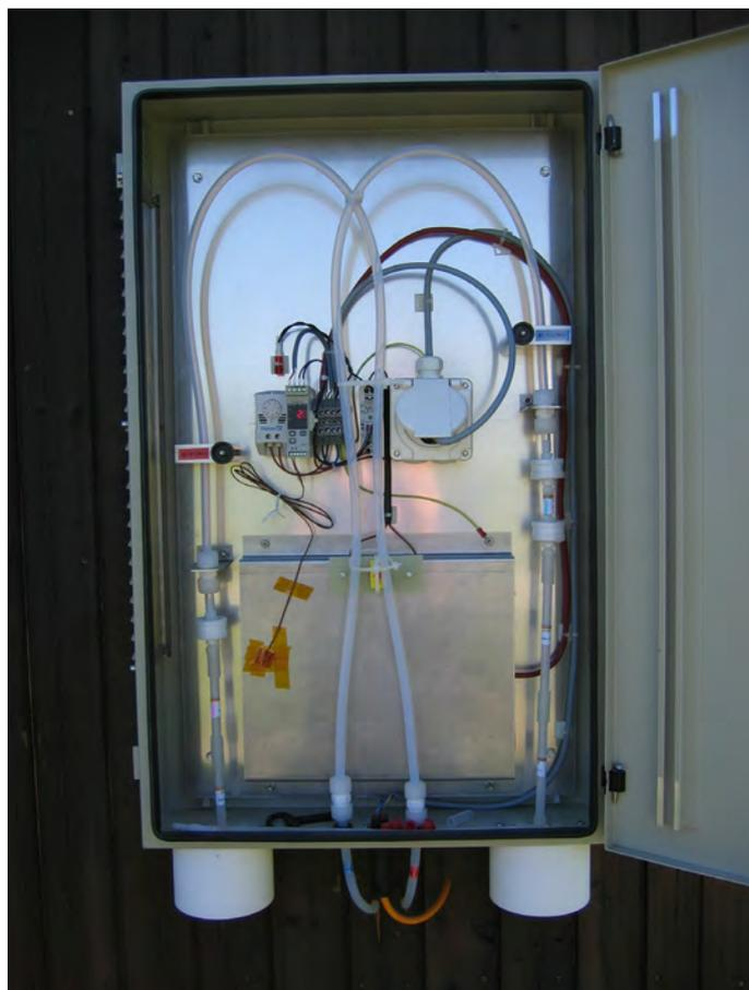
Abb. 3-36: Probenahme Minidenuder-System (MD-System)
