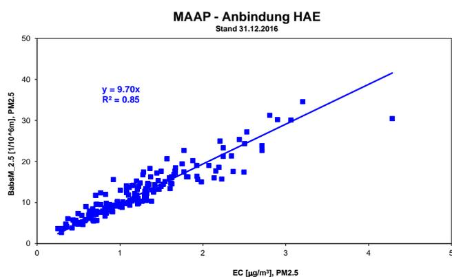
Abb. A4-2: Vergleich von kontinuierlichen MAAP-Messungen mit EC-Messungen (TOT Messungen) am Standort Härkingen (Messperiode: 1.1.2011 - 31.12.2016)
