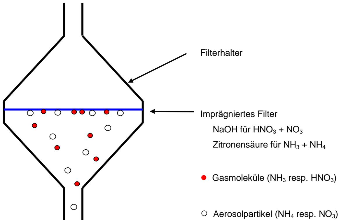
Abb. A5-1: Schematische Darstellung des Messprinzips mit imprägnierten Filtern zur Messung der Summen von Salpetersäure+Nitrat, resp. Ammoniak+Ammonium
