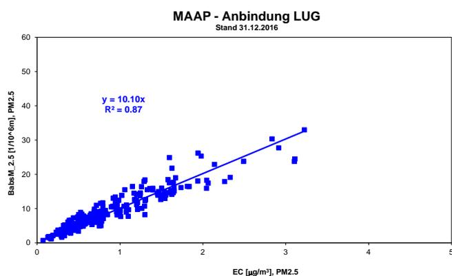
Abb. A4-3: Vergleich von kontinuierlichen MAAP-Messungen mit EC-Messungen (TOT Messungen) am Standort Lugano (Messperiode: 1.1.2011 - 31.12.2016)
