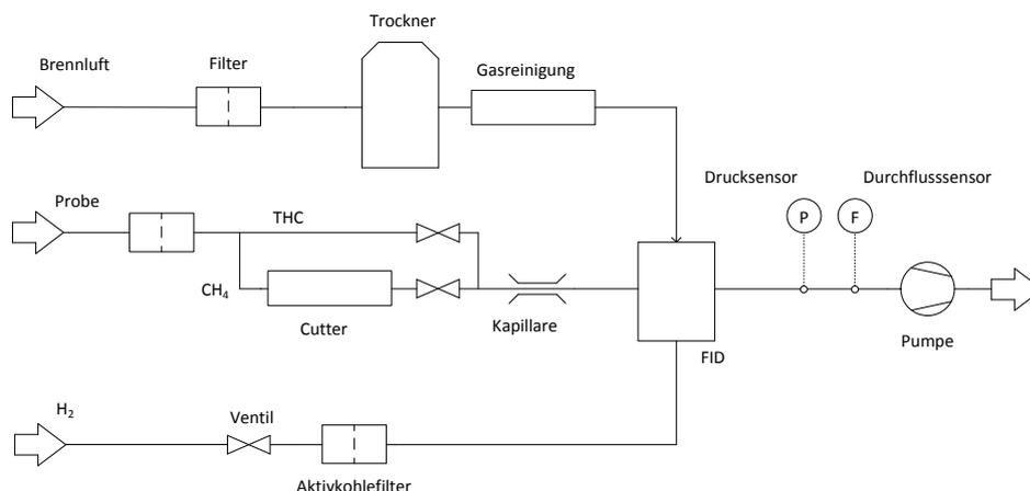
Abb. 3-15: Schematischer Geräteaufbau eines Messgerätes für Nichtmethankohlenwasserstoffe
