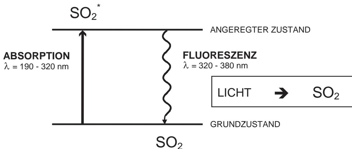
Abb. 3-1: Reaktionsprinzip
