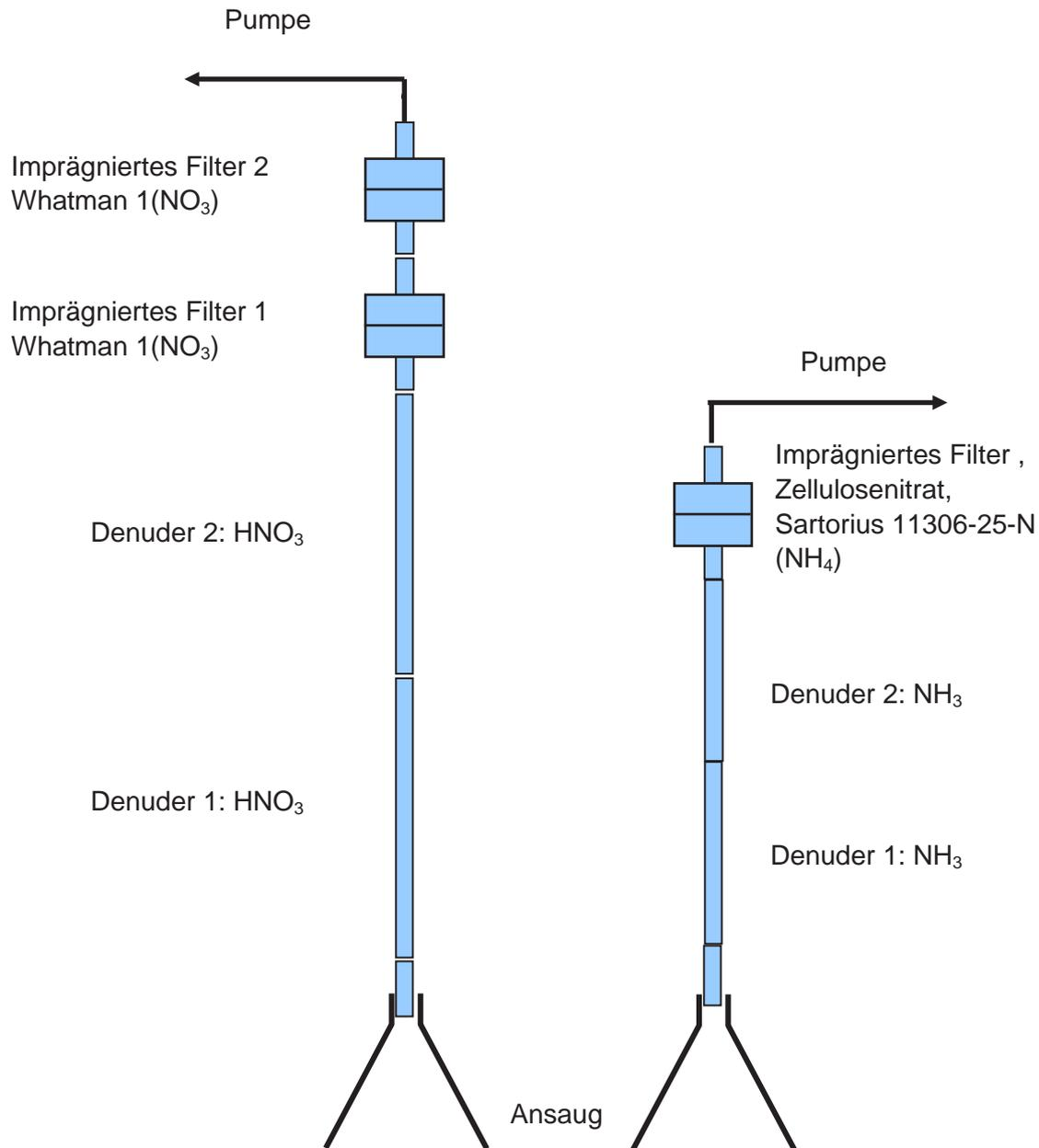
Abb. A5-4: Anordnung der Komponenten im modifizierten Minidenudersystem mit getrennten Linien für Salpetersäure/Nitrat und Ammoniak/Ammonium
