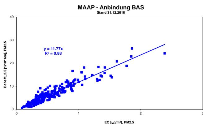
Abb. A4-1: Vergleich von kontinuierlichen MAAP-Messungen mit EC-Messungen (TOT Messungen) am Standort Basel (Messperiode: 16.2.2008 - 31.12.2016)
