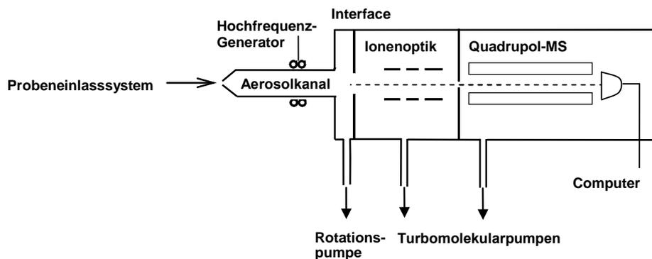
Abb. 3-23: Schematische Darstellung des ICP-MS
