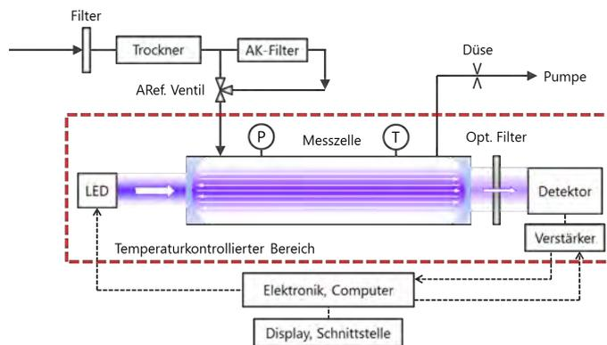
Abb. 3-9: Schematischer Geräteaufbau vom CAPS-Analysator T500U
