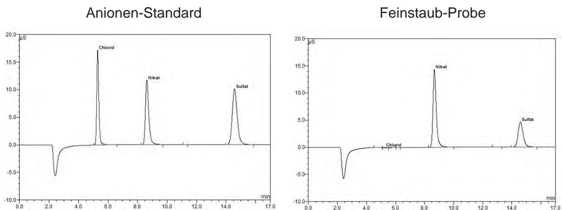
Abb. 3-24: IC-Chromatogramm von Anionen-Standard und Feinstaub-Probe
