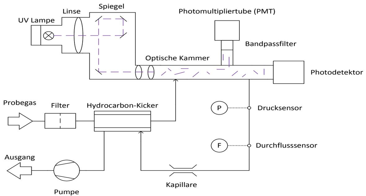
Abb. 3-2: Schematischer Geräteaufbau eines SO<sub>2</sub>-Messgerätes
