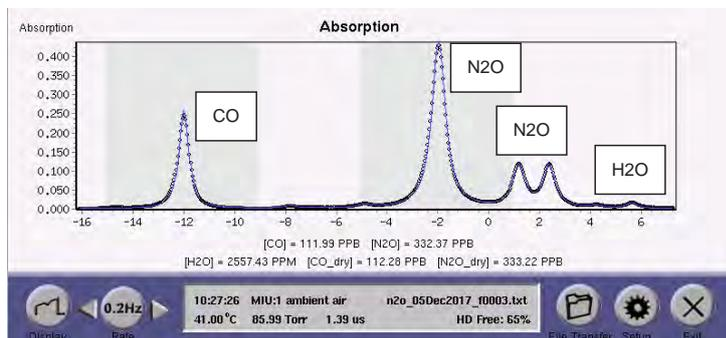
Abb. 3-18 Beispiel eines Absorptionsspektrums von N<sub>2</sub>O, CO und H<sub>2</sub>O.
