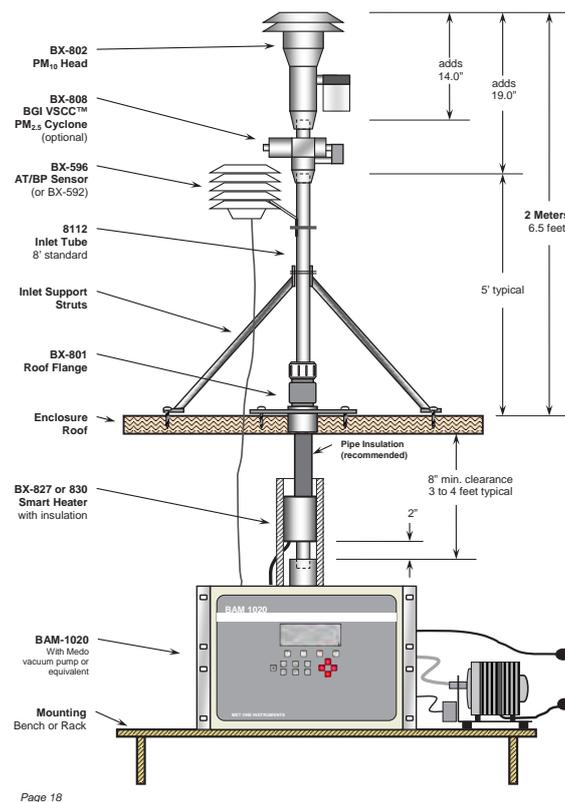
Abb. 3-20: Überblick Gesamtsystem BAM 1020 (Quelle : MetOne Instruments, Inc.)
