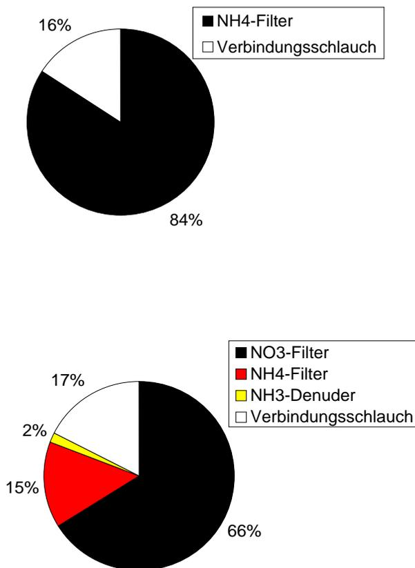
Abb. A5-7: Deposition von Ammonium (oben) und Nitrat (unten) beim DELTA-Minidenudersystem. Schwarz: Abscheidung am richtigen Ort, auf dem dafür vorgesehenen imprägnierten Filter. Farbig/Weiss: Abscheidung auf anderen Komponenten des Systems (Depositionsverluste im System).
