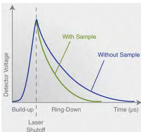
Abb. 3-14: Abnahme der Lichtintensität mit und ohne Beitrag durch Absorption an Gasmolekülen
