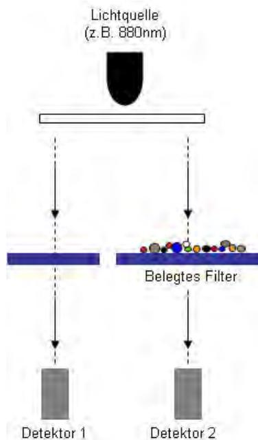
Abb. 3-27: Schematischer Geräteaufbau eines Russmonitor Magee Aethalometer AE31
