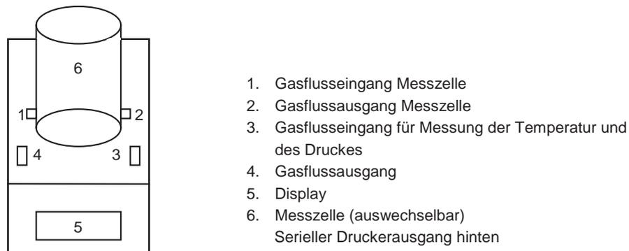
Abb. 4-6: Schematischer Aufbau des DryCal
