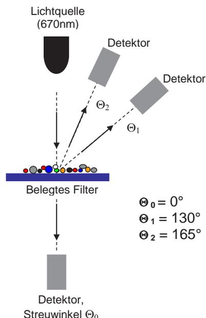
Abb. 3-26: Schematischer Geräteaufbau eines Russmonitor CARUSSO/MAAP5012
