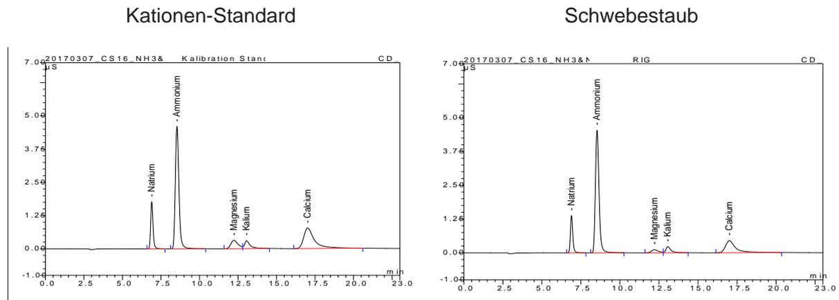
Abb. 3-25: IC-Chromatogramm Kationen-Standard und Kationen im Schwebestaub
