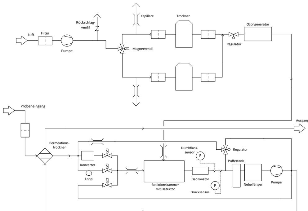
Abb. 3-4: Schematischer Geräteaufbau eines NO<sub>x</sub>-Messgerätes
