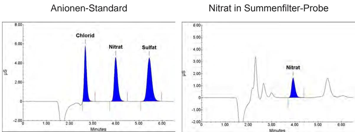
Abb. 3-33: IC Chromatogramm Anionen-Standard und Summenfilter-Probe (Nitrat)
