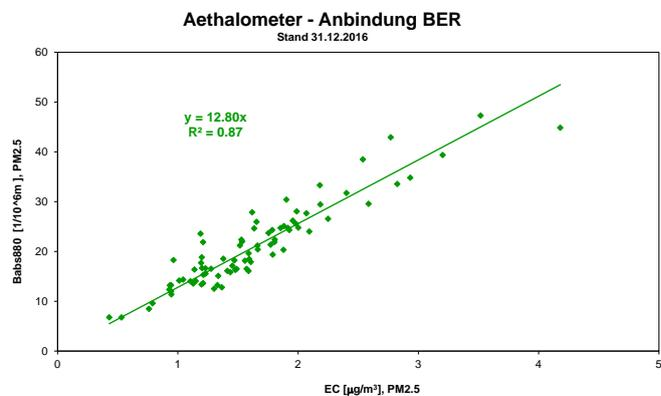
Abb. A4-8: Vergleich von kontinuierlichen Aethalometer-Messungen mit EC-Messungen (TOT Messungen) am Standort Bern (Messperiode: 12.12.13 - 31.12.2016)
