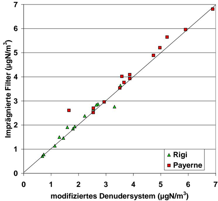
Abb. A5-8: Vergleich der Messungen von Ammoniak+Ammonium mit dem modifizierten Denudersystem mit den parallelen Summenmessungen auf imprägnierten Filtern.
