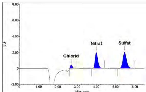
Abb. 3-30: IC-Chromatogramm Anionen-Standard und Regenprobe
