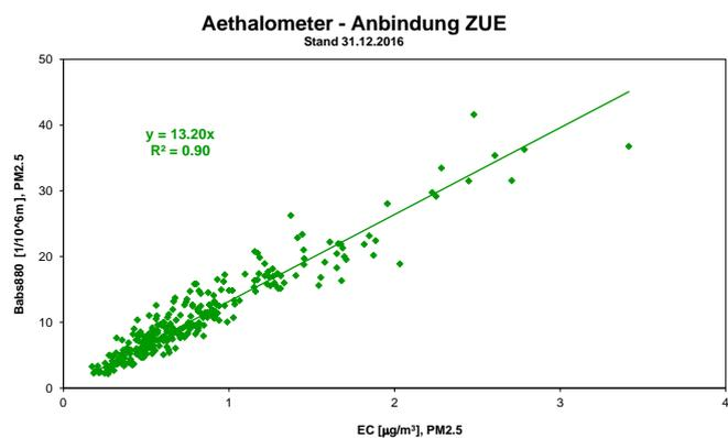
Abb. A4-7: Vergleich von kontinuierlichen Aethalometer-Messungen mit EC-Messungen (TOT Messungen) am Standort Zürich (Messperiode: 3.4.2009 - 31.12.2016)
