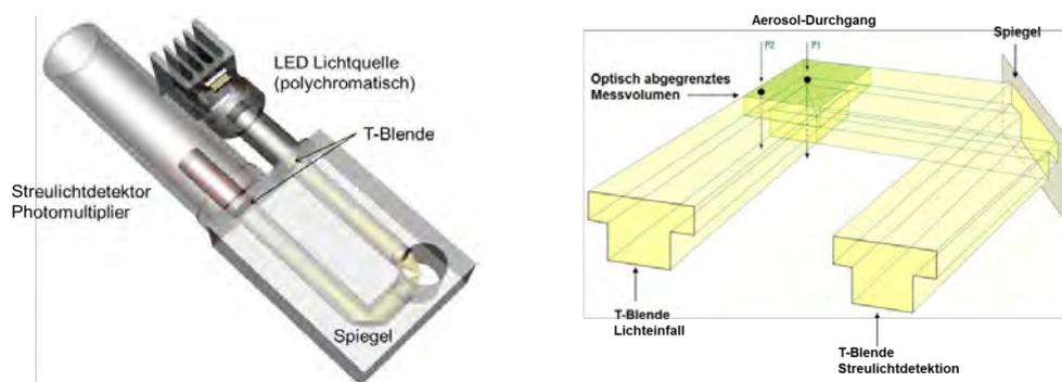
Abb. 3-22: Aufbau des Sensors des Fidas Messsystems und Veranschaulichung der T-Blende (Quelle: Bedienungsanleitung Feinstaubmonitorsystem Fidas, PALAS GmbH)
