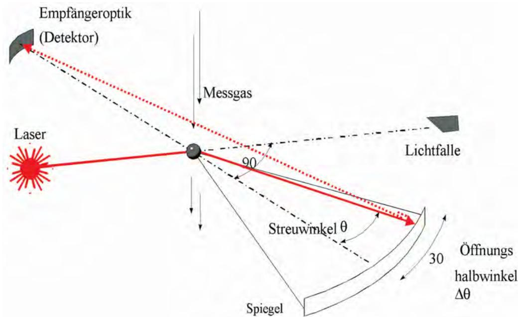
Abb. 3-21: Schematischer Geräteaufbau eines Staubmessgerätes EDM 365 (Quelle: Grimm Aerosol Technik GmbH)
