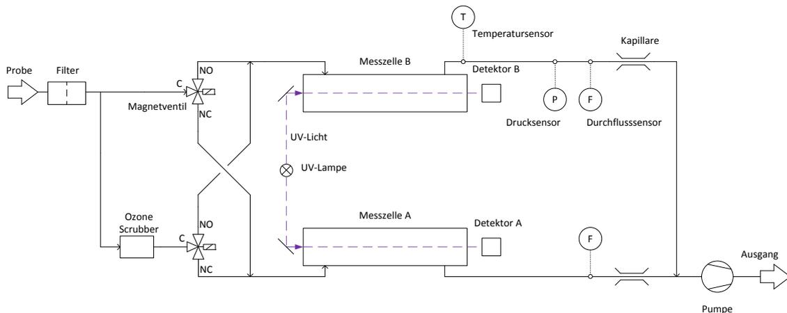
Abb. 3-11: Schematischer Geräteaufbau eines Ozon Messgerätes mit zwei Messzellen
