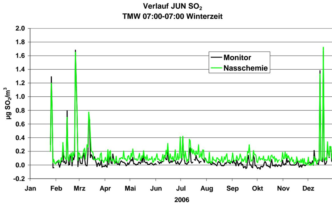
Abb. A2-1: Verlauf der SO<sub>2</sub> Konzentration am Standort Jungfrauoch mit zwei unterschiedlichen Messmethoden
