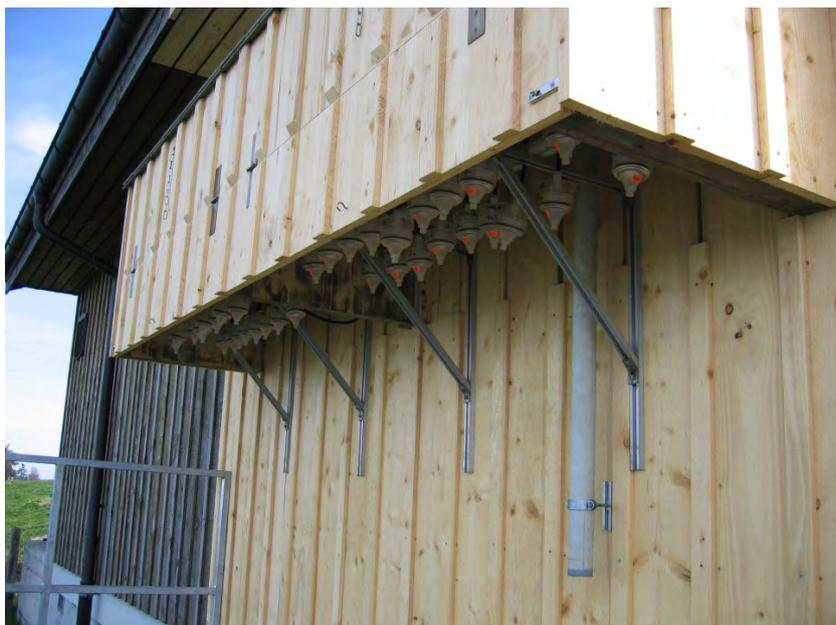
Abb. 3-32: Probenahme Stickstoffaerosole
