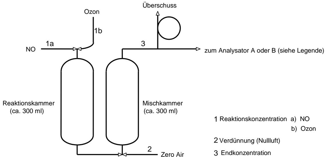
Abb. 3-6: Detaillierte Darstellung der Reaktions- und Mischkammer
