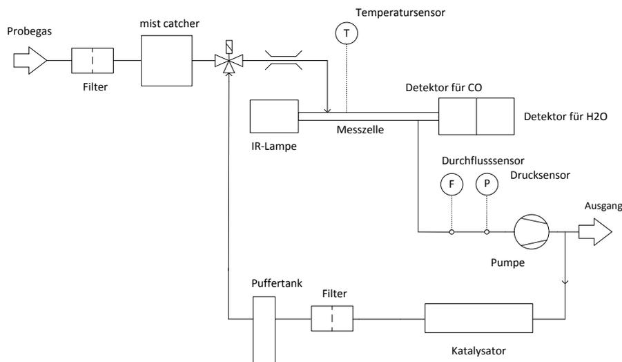
Abb. 3-12: Schematischer Geräteaufbau eines CO-Messgerätes
