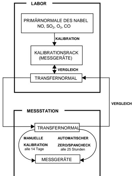
Abb. 4-8: Rückverfolgbarkeit Komponenten CO, NO, O<sub>3</sub> und SO<sub>2</sub>
