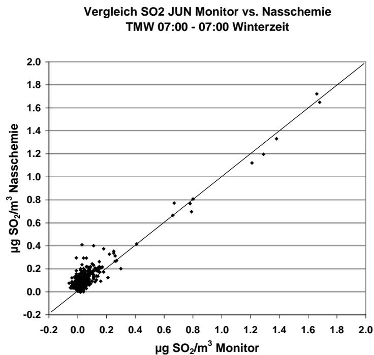
Abb. A2-2: Parallelmessung SO<sub>2</sub> am Standort Jungfrauoch mit zwei unterschiedlichen Messmethoden
