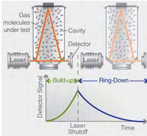
Abb. 3-13: Schematische Darstellung des Cavity Ring Down Spektrometers
