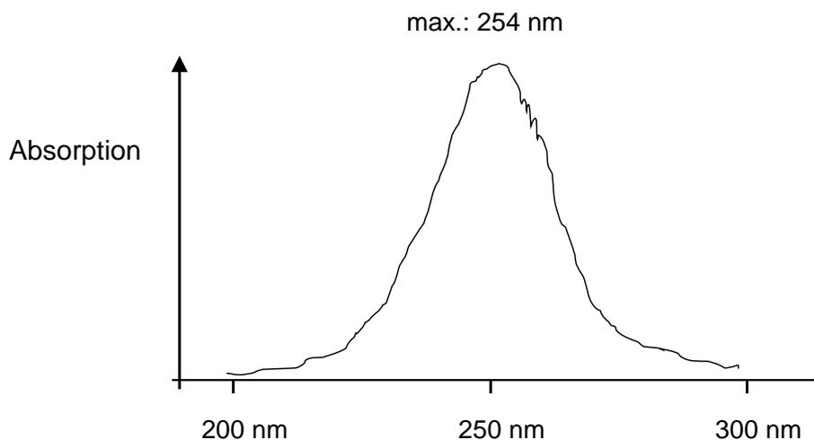
Abb. 3-10: Absorptionsspektrum von Ozon
