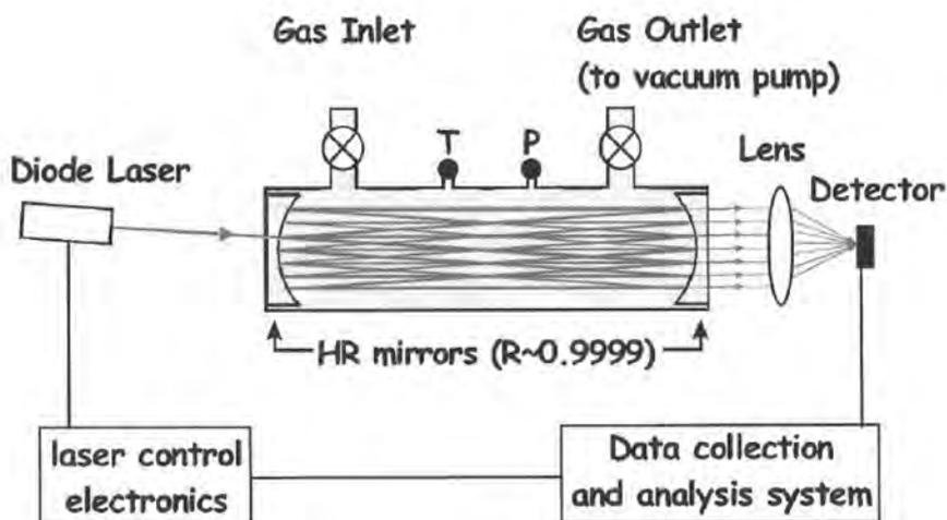
Abb. 3-17: Schematischer Aufbau des Laserspektrometers für die Detektion von Lachgas (Quelle: Los Gatos Research, Inc.)
