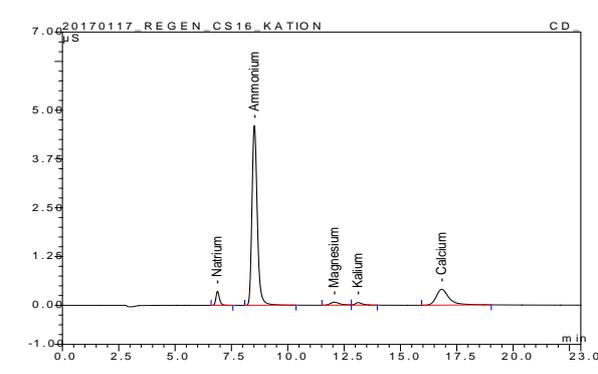
Abb. 3-31: IC-Chromatogramm Kationen-Standard und Regenprobe
