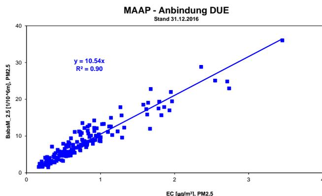
Abb. A4-4: Vergleich von kontinuierlichen MAAP-Messungen mit EC-Messungen (TOT Messungen) am Standort Dübendorf (Messperiode: 1.1.2011 - 31.12.2016)
