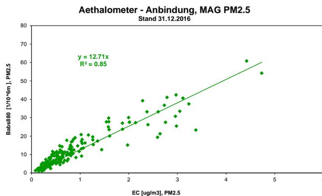
Abb. A4-5: Vergleich von kontinuierlichen Aethalometer-Messungen mit EC-Messungen (TOT Messungen) am Standort Magadino (Messperiode: 4.4.2008 - 31.12.2016)
