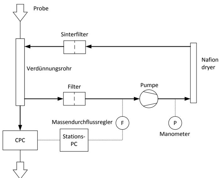
Abb. 3-28: CPC-Verdünnungseinheit
