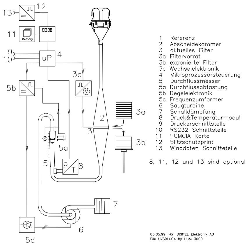
Abb. 3-19: Schematische Darstellung eines Probenahmeapparates DA-80H von Digital
