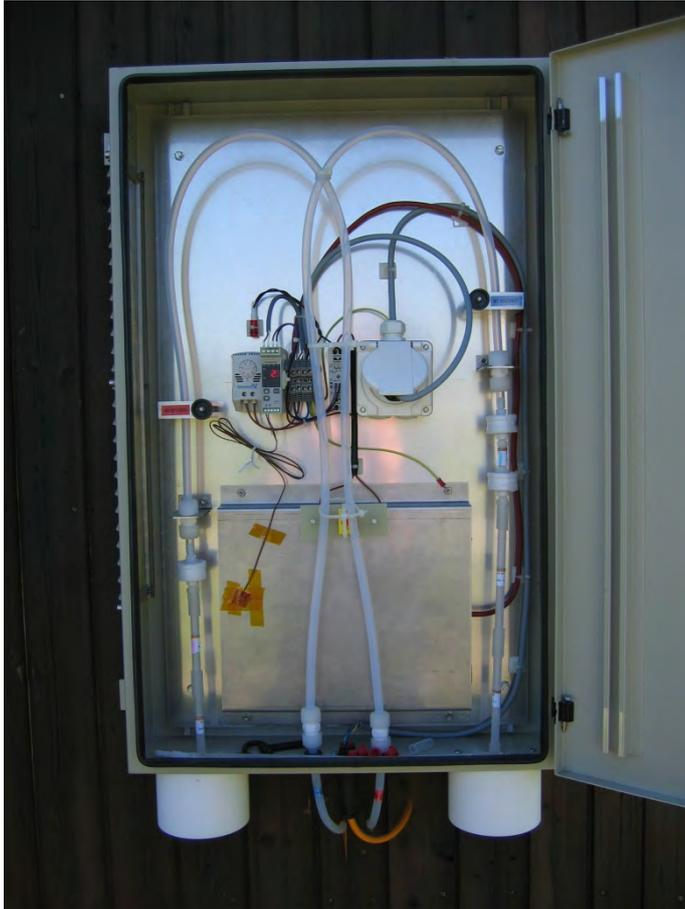
Abb. 3-32: Probenahme Minidenuder-System (MD-System)
