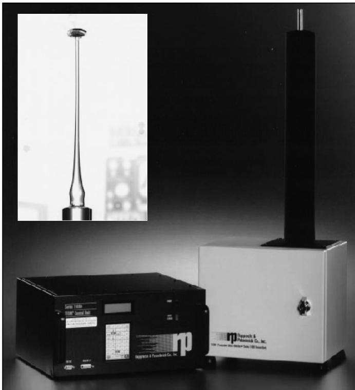
Abb. 3.4: TEOM 1400 (Ruppert & Patashnick) und Hohlzylinder/Filter.
