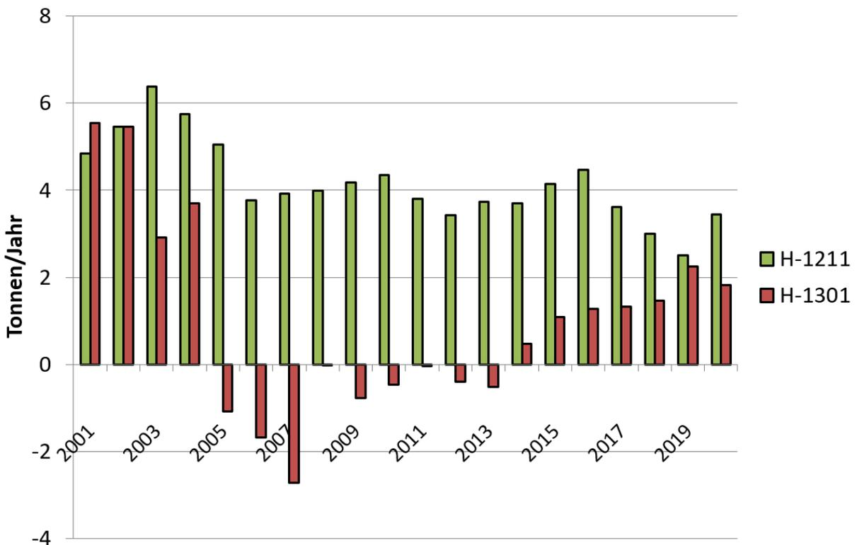
Abbildung 34: Mit Messungen auf dem Jungfraujoch abgeschätzte Schweizer Emissionen von ozonzerstörenden bromierten Substanzen, welche durch das Montrealer Protokoll reguliert sind (als arithmetisches Mittel über 3 Jahre). Negative Werte sind durch die Unsicherheiten der Abschätzungen begründet.
