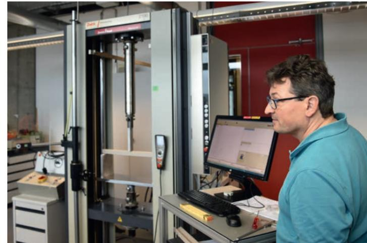
Der Experte Markus Hilber von der Empa und seine Maschine. Sie drückte mit dem Prüfstempel nach den Belastungsvorgaben des Fachmanns auf die Mitte der Brücken. Eine Software zeichnete die Versuchsverläufe in einem Diagramm am Bildschirm nach.
