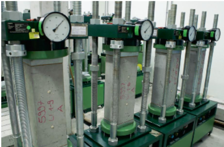
Wie verhält sich Beton unter langanhaltendem Druck? Mit einer ganzen Batterie von Druckständen gehen die Wissenschaftler dieser Frage nach.
