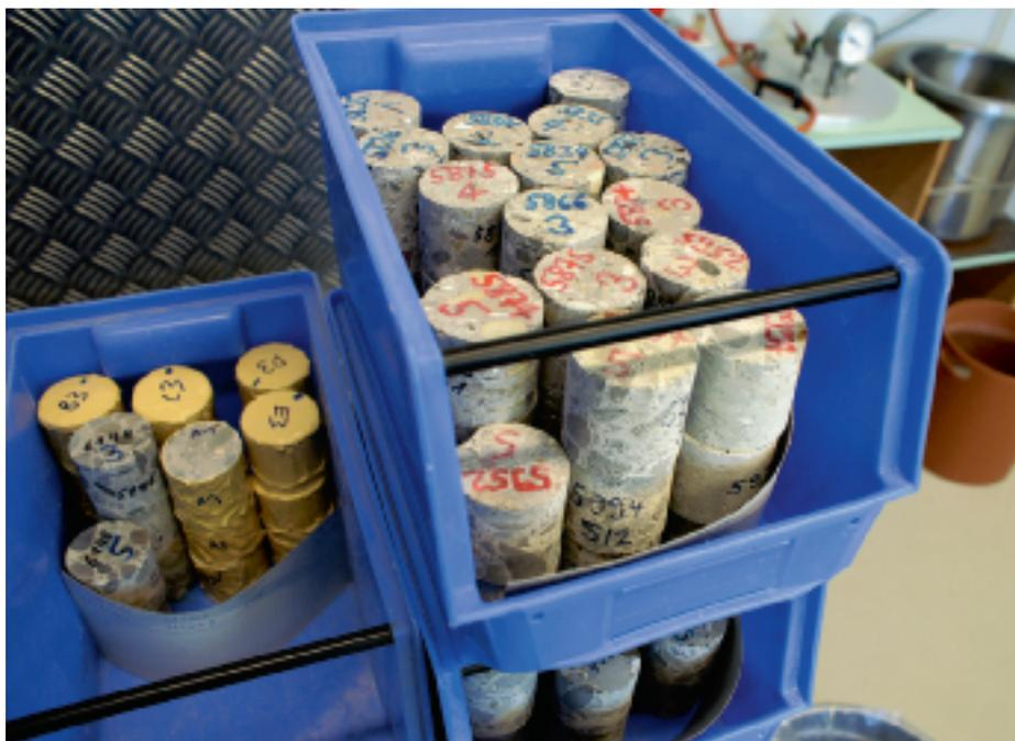
Keine Probe ist wie die andere: Beton weist eine äusserst heterogene Zusammensetzung auf.
