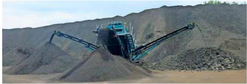
Bild 1: Ausbauspalthaufen mit Brech-/Siebeinheit
