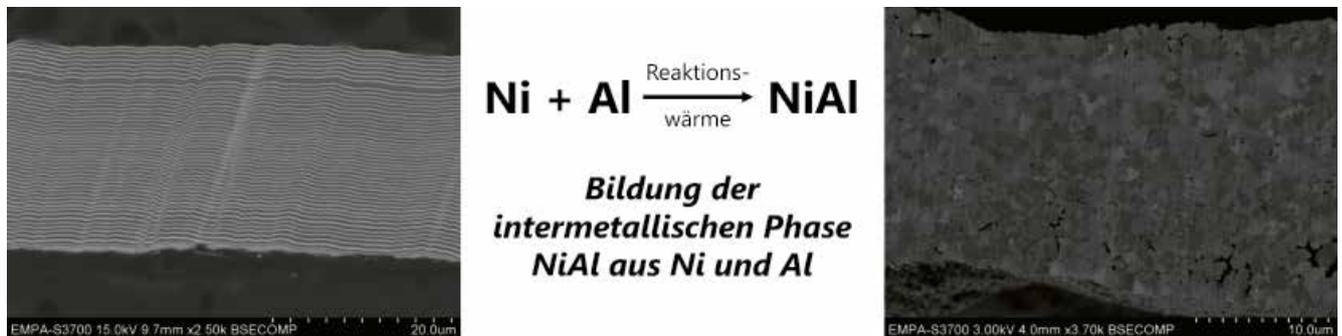
Abb. 1: Rasterelektronenmikroskopie-Aufnahme einer Ni-Al RNMS-Folie vor (links) und nach (rechts) der Reaktion zu NiAl.
