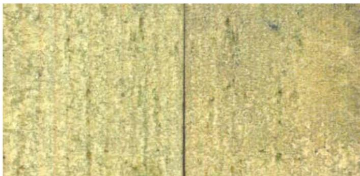
Abb. 75 Bruchfläche mit Kohäsionsbruch im Klebstoff
