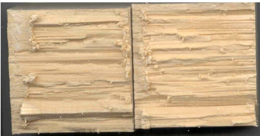
Abb. 2 Bruchfläche einer mit MUF verklebten Fichte
