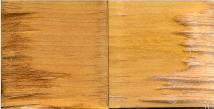
Abb. 36 Lugolsche Lösung anschl. Natriumthiosulfat-Lsg. auf Fichte / PUR
