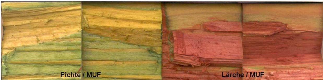
Abb. 37 Universalindikator auf Fichte / MUF bzw. Lärche / MUF
