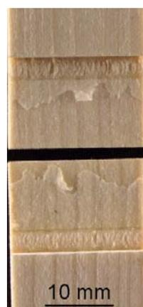
Abb. 5 Probekörper aus Fichte mit 0% Faserbruchanteil
