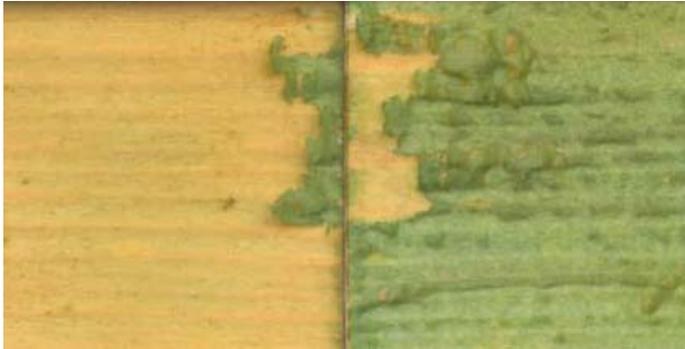
Abb. 77 Bruchfläche mit Adhäsionsbruch
