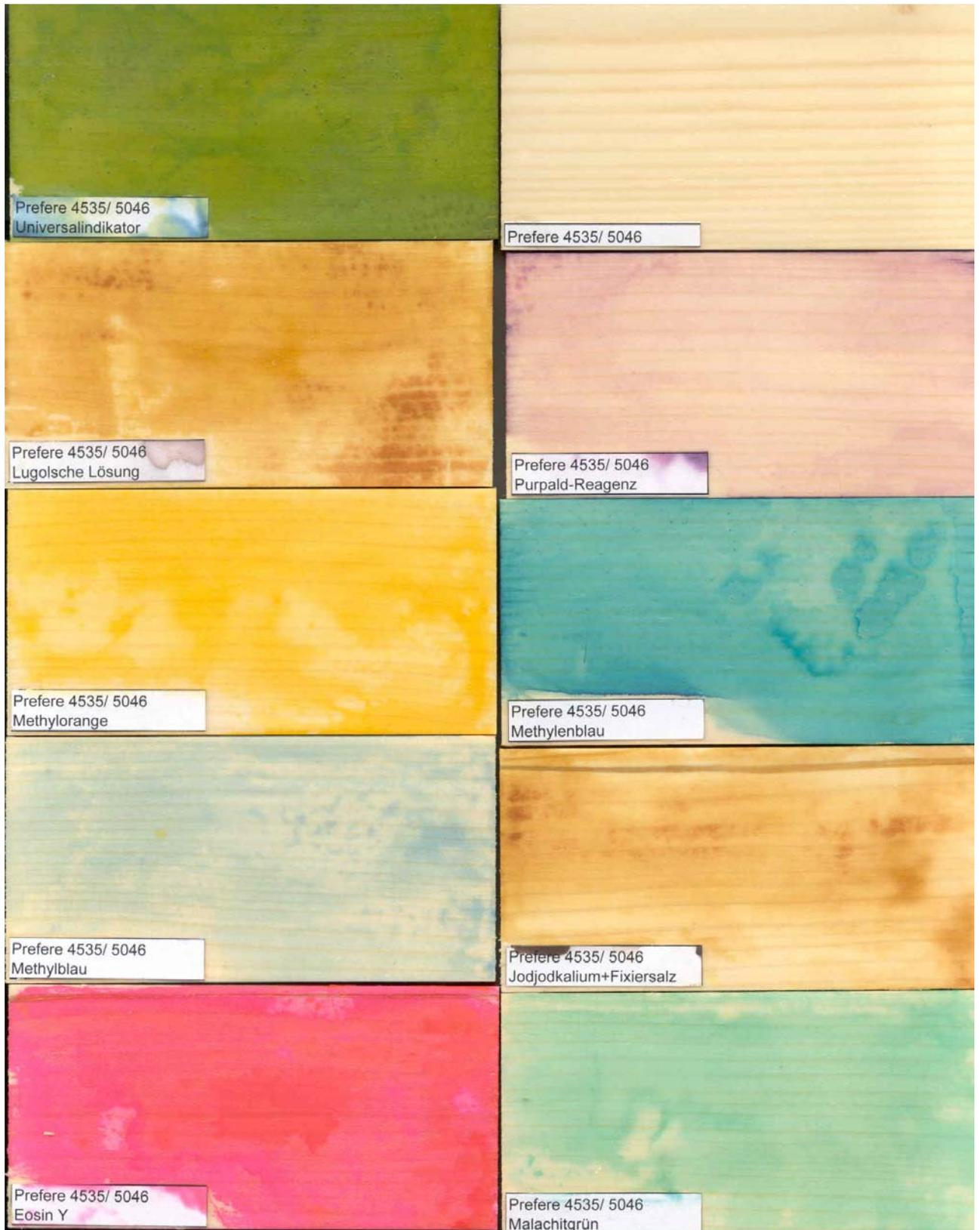
Abb. 23 Farbreaktionen auf Prefere 4535/5046 (MUF) luftgetrocknet
