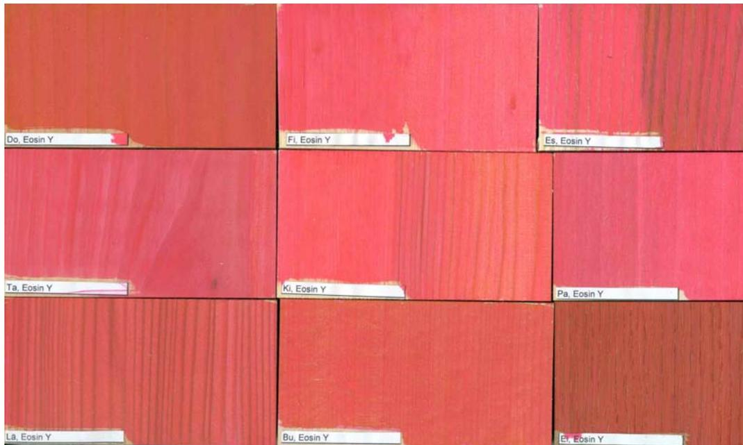
Abb. 10 Gehobelte Holzproben gestrichen mit Eosin G, luftgetrocknet
