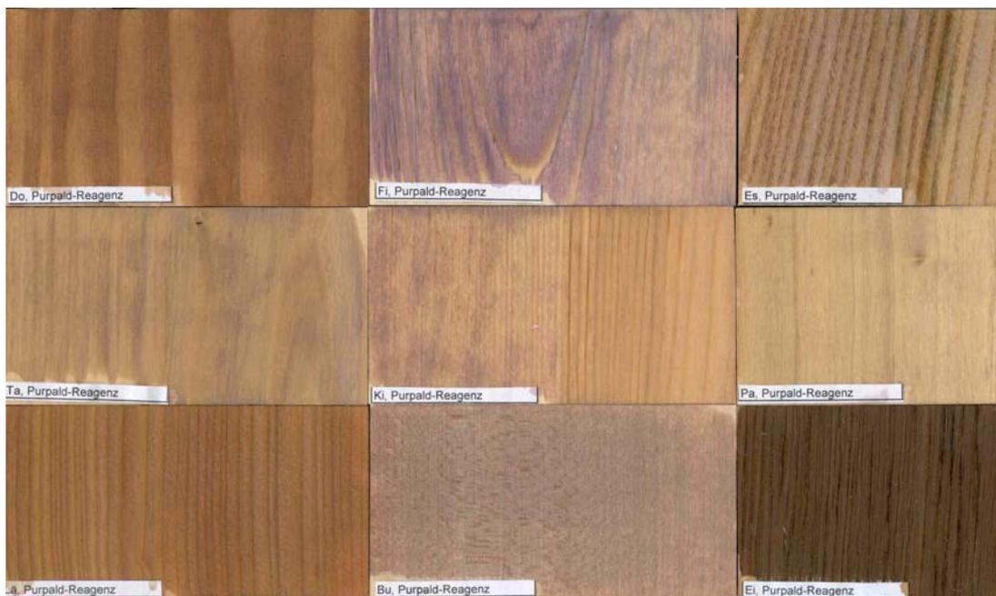
Abb. 15 Gehobelte Holzproben gestrichen mit Purpald-Reagenz, luftgetrocknet
