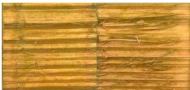
Abb. 74 Bruchfläche mit Kohäsionsbruch im Holz
