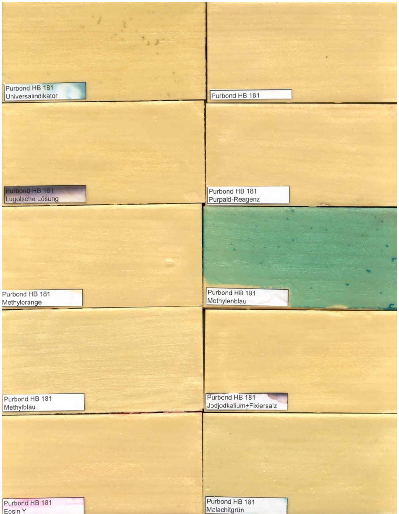
Abb. 19 Farbreaktionen auf Purbond HB 181 luftgetrocknet
