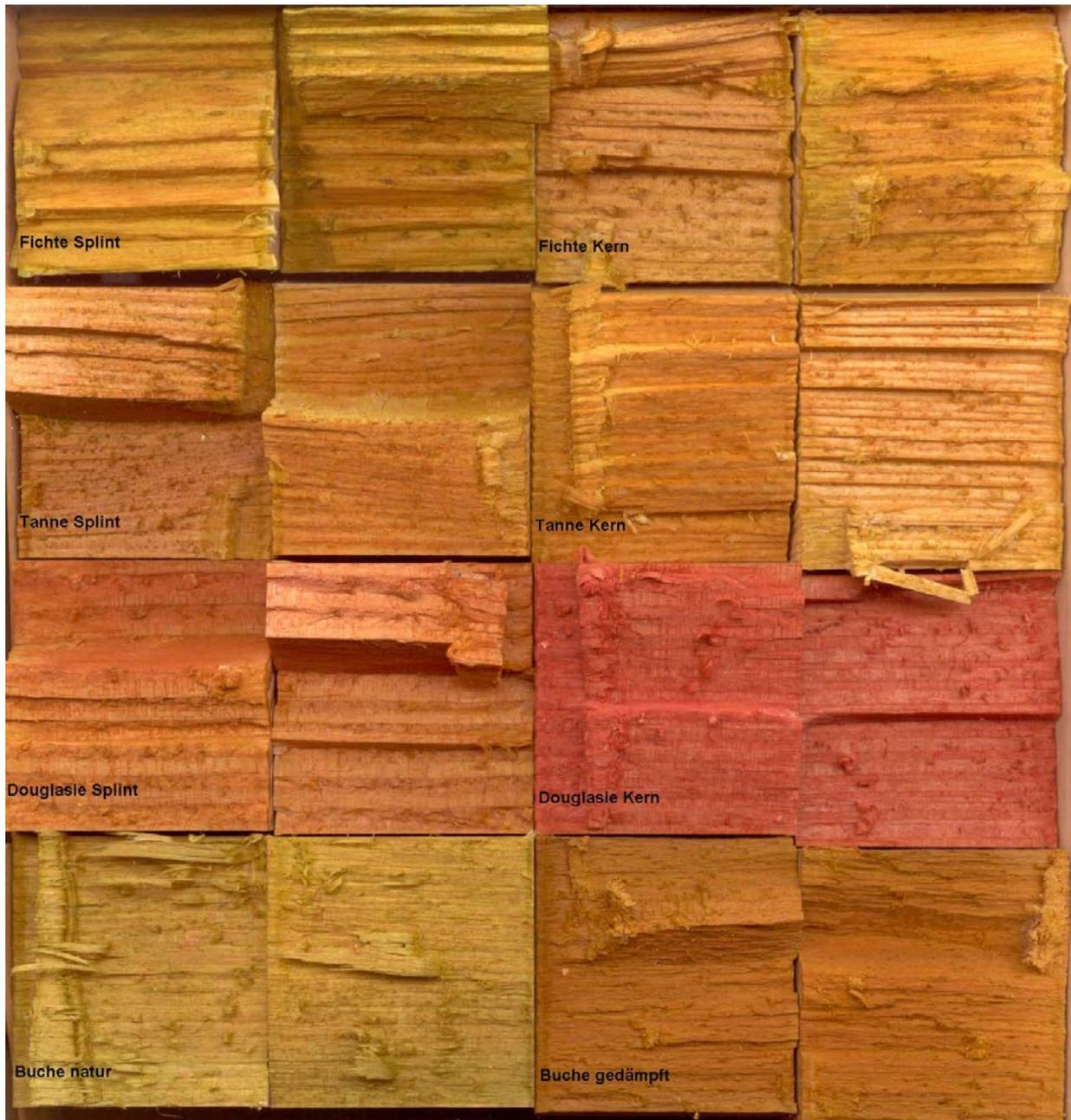
Abb. 17 Bruchflächen ausgewählter Holzarten, besprüht mit Universalindikator
