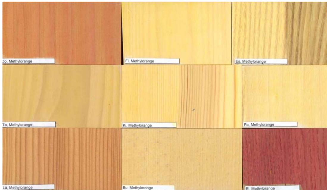
Abb. 12 Gehobelte Holzproben gestrichen mit Methylorange, luftgetrocknet
