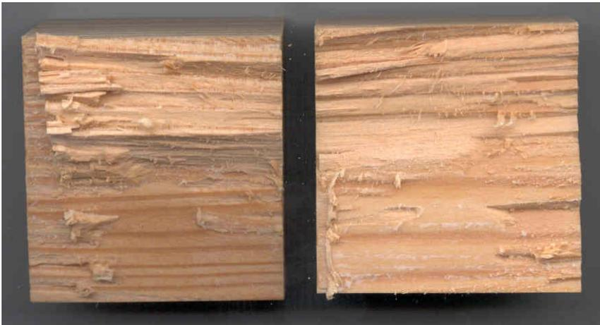
Abb. 1 Bruchfläche einer mit 1P-PUR verklebten Europäischen Lärche
