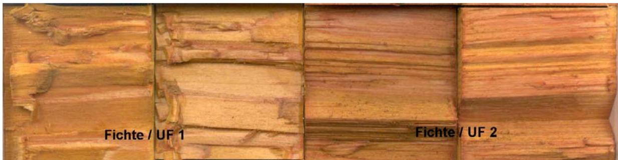
Abb. 41 Universalindikator auf Fichte / UF
