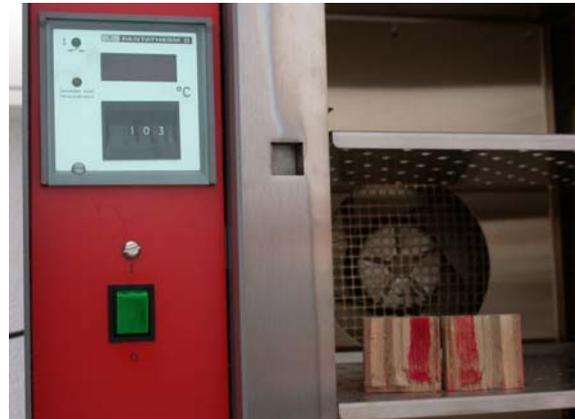
Abb. 62 Trockenschrank zur Wärmebehandlung (20 min bei ca. 100 °C)
