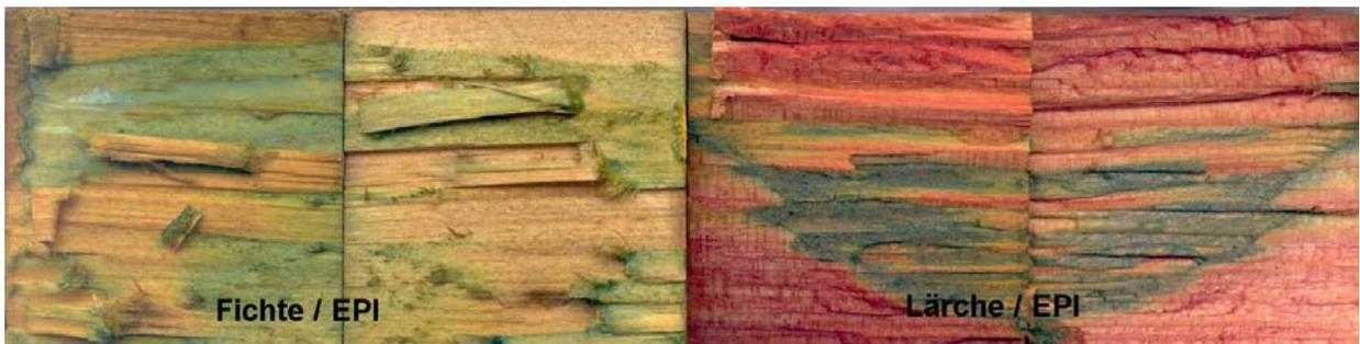
Abb. 48 Universalindikator auf Fichte / EPI bzw. Lärche / EPI
