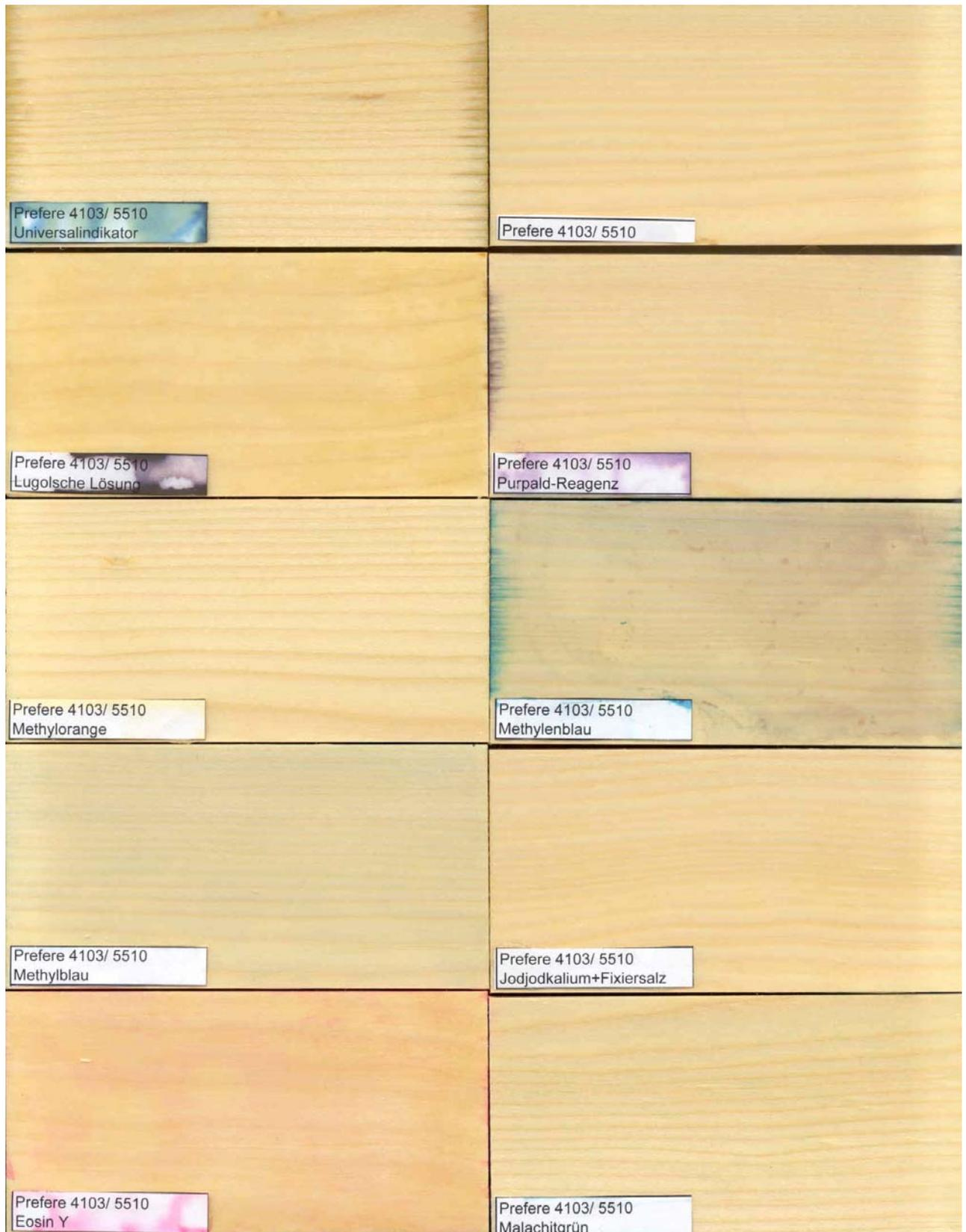
Abb. 26 Farbreaktionen auf Prefere 4103/ 5510 (UF) luftgetrocknet
