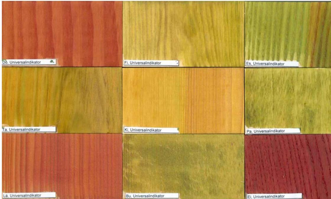
Abb. 16 Gehobelte Holzproben gestrichen mit Universalindikator, luftgetrocknet
