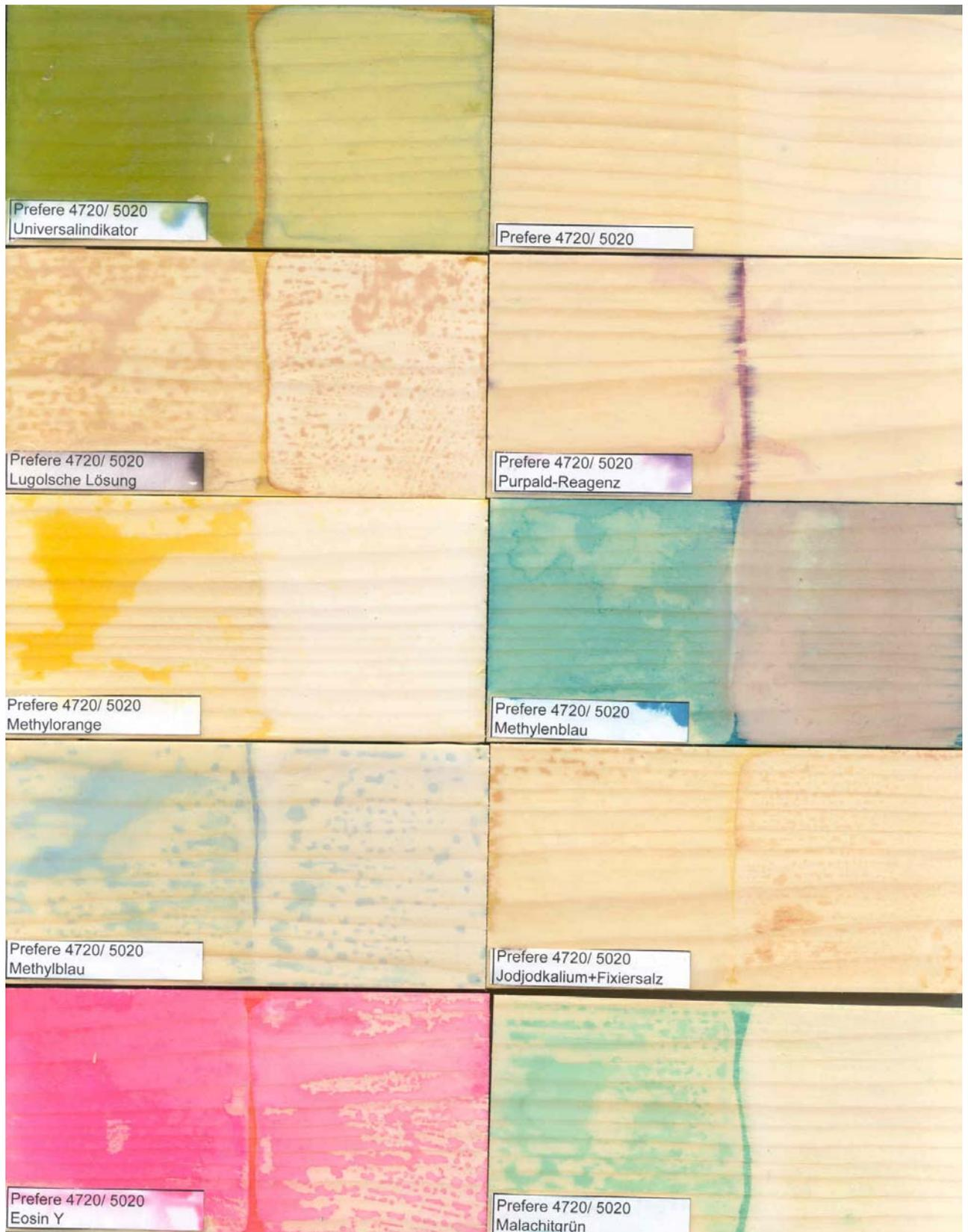
Abb. 25 Farbreaktionen auf Prefere 4720/ 5020 (MF) luftgetrocknet;
