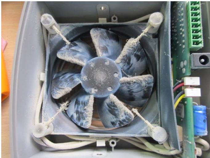
*Abb. Ionisierlüfter: Beispiel eines Ionisierlüfters nach mehrmonatigem Einsatz ohne Reinigung in einer Assemblerlinie (Reinraum sic!); Die Nadeln sind so stark mit Staub zugesezt, dass keine Coronaentladung mehr möglich ist; die Wirkung ist dann gleich Null*
