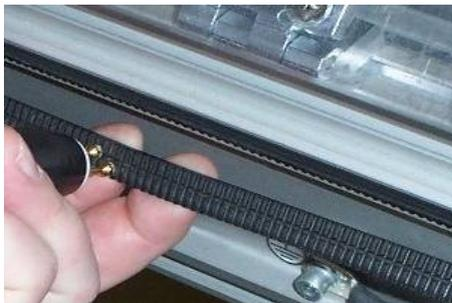
Bild 5.6.2.3 Transportriemen aus volumendissipativem Material
