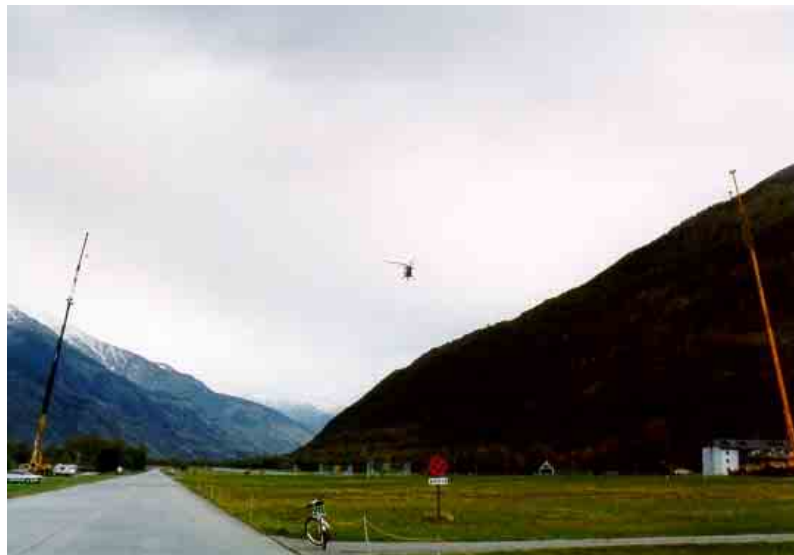
Abbildung 5 Messanordnung für die Vermessung von Helikoptern in Turtmann: Helikopter haben eine grundsätzlich andere Schallabstrahlung als Flächenflugzeuge. Entsprechend musste die Anordnung der Messmikrofone angepasst werden. Das Bundesamt für die Betriebe der Luftwaffe (BABLW) stellte zur Vermessung der Helikopter zwei Autokrane mit Auslegern von je ca. 50 Metern zur Verfügung. An die Ausleger wurden je fünf Mikrofone gehängt. Die Krane wurden in einem Abstand von ca. 150 Metern einander gegenüber aufgestellt. Dazwischen standen fünf Masten mit je einem Mikrofon am Boden und einem in fünf Metern Höhe. Insgesamt wurden 20 synchron geschaltete Mikrofone eingesetzt. Die Helikopter flogen wiederholt zwischen den Kranmasten hindurch. Auf diese Weise lässt sich ein dreidimensionales Bild der Schallabstrahlung erzeugen.
