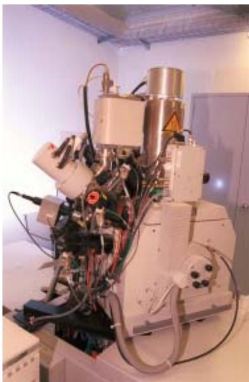
Chambre à échantillons Dual-Beam-FIB- avec colonne électronique (en haut) et colonne latérale à ions (à gauche). Les dispositifs supplémentaires servent à l'introduction des gaz (injecteurs) et à la détection des signaux.
