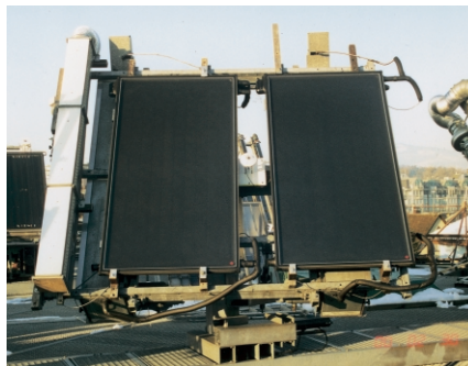
Energie effizient nutzen: Sonnenkollektor auf dem Prüfstand in Rapperswil
