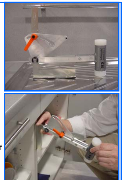
Abbildung 4: Empa-Pendelfallhammer zur Simulation von Benutzungsgerauschen haustechnischer Anlagen und fester Einrichtungen im Gebäude.
