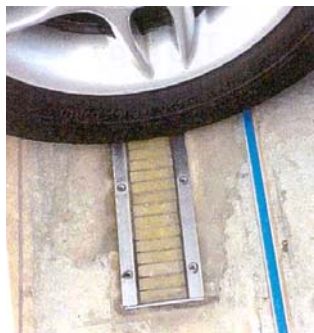
Le capteur modulaire développé par Kistler Instruments AG
