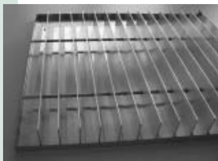
Fig. 2: Wärmeleitlamellen aus Aluminium vor dem Giessen des Komposits. Bild: TRANSSOLAR
