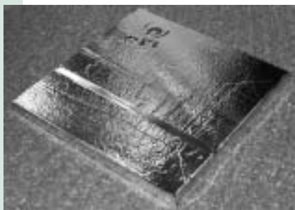
Fig. 1: VIP-Paneele bestehend aus einem nanoporösen Kernmaterial und einer möglichst gasdichten Hüllfolie mit verschweissten Rändern.
