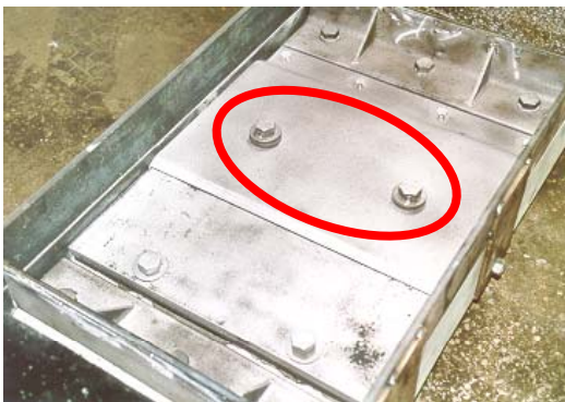
Bild 7 Aussehen eines Prüfkörpers SJ900 mit Schrauben "mit vorstehenden Schraubenköpfen" vor der Herstellung.
