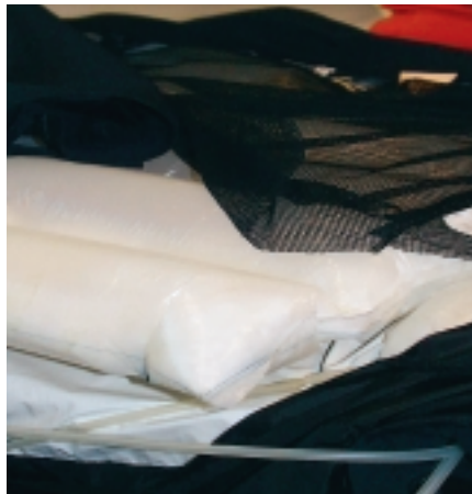
Prototyp einer mit variabler Wärmeisolation ausgerüsteten Outdoor-Jacke: Mit Luft gefüllt (links) und leer (rechts)
