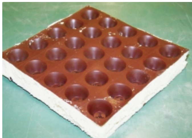
SANOP-Element mit ausgeschäumtem Hohlraum.
