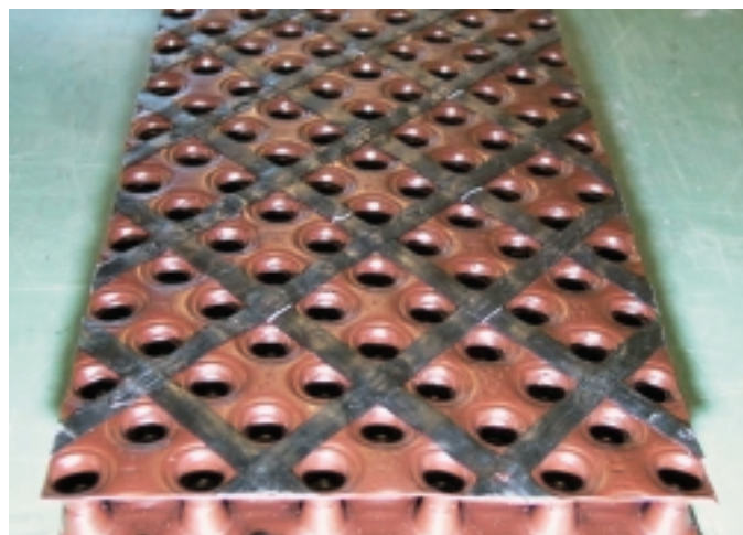
SANOP-Platte mit aufgeklebten Bändern aus kohlefaserverstärktem Kunststoff (CFK) zur Versteifung.
