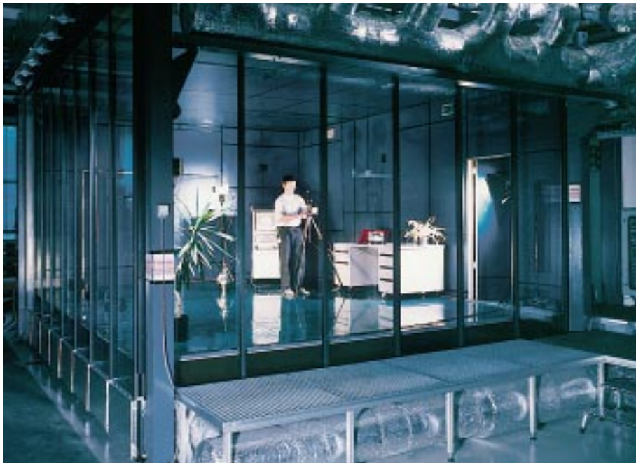
Der Testraum des Raumklima-Labors an der EMPA in Dübendorf hat die Abmessungen von 6.16 x 4.62 x 3.0 Meter. Länge, Breite und Höhe können variiert werden.
