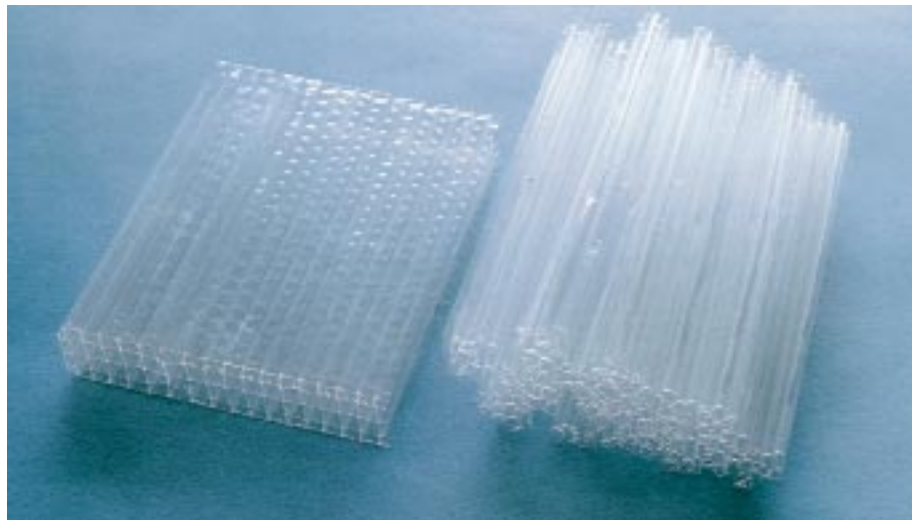
Waben- und Kapillarstrukturen aus transparenten Kunststoffolien für die transparente Wärmedämmung.
