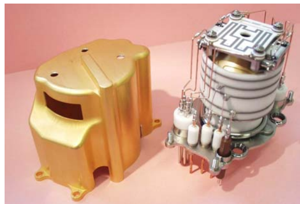
Source d'ions du spectromètre de masse à temps de vol ROSINA-RTOF pour la mesure des gaz non ionisés
