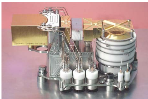
Source d'ions du spectromètre de masse à temps de vol ROSINA-RTOF pour la mesure des gaz ionisés
