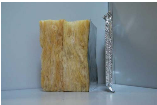
Comparaison entre isolation conventionnelle et isolation sous vide
