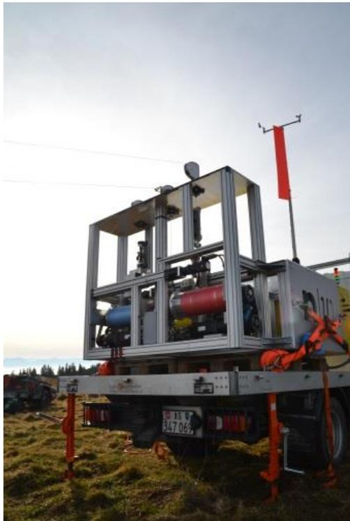
Die Bodenstation wird in Position gebracht. An den Kurbeln wird der Kite befestigt und in der Luft gehalten, während der Zug darauf in Strom umgewandelt wird.
