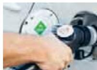
L'Empa possède la première station service d'hydrogène de Suisse avec une pression de remplissage de 700 bar pour les voitures de tourisme. Cette station service fait partie du démonstrateur de mobilité «move» et est utilisée pour différents véhicules tests de l'Empa ainsi que par les voitures à hydrogènes de détenteurs privés.
